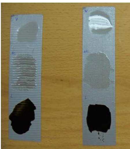
Slika 7: Preskušanje podlage – lepilni trak s polietilenskim filmom
