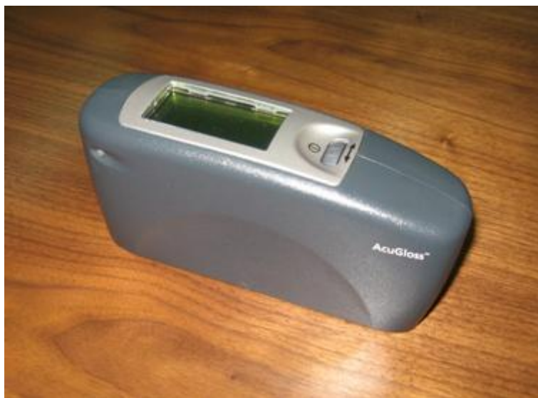
Slika 5: Merilec sijaja X-Rite AcuGloss TRI
