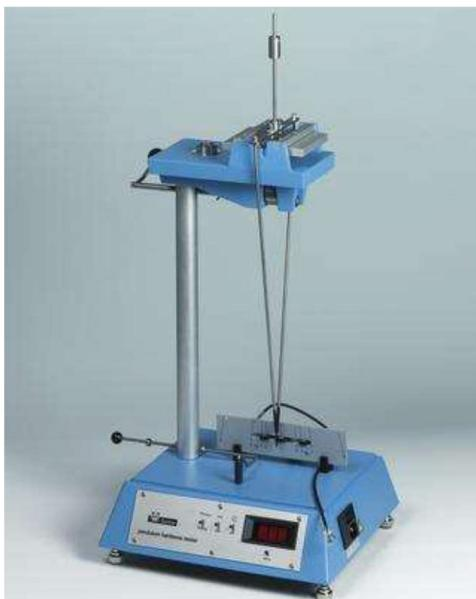
Slika 19: Pendulum Damping Tester (Kričej, 2008c)
