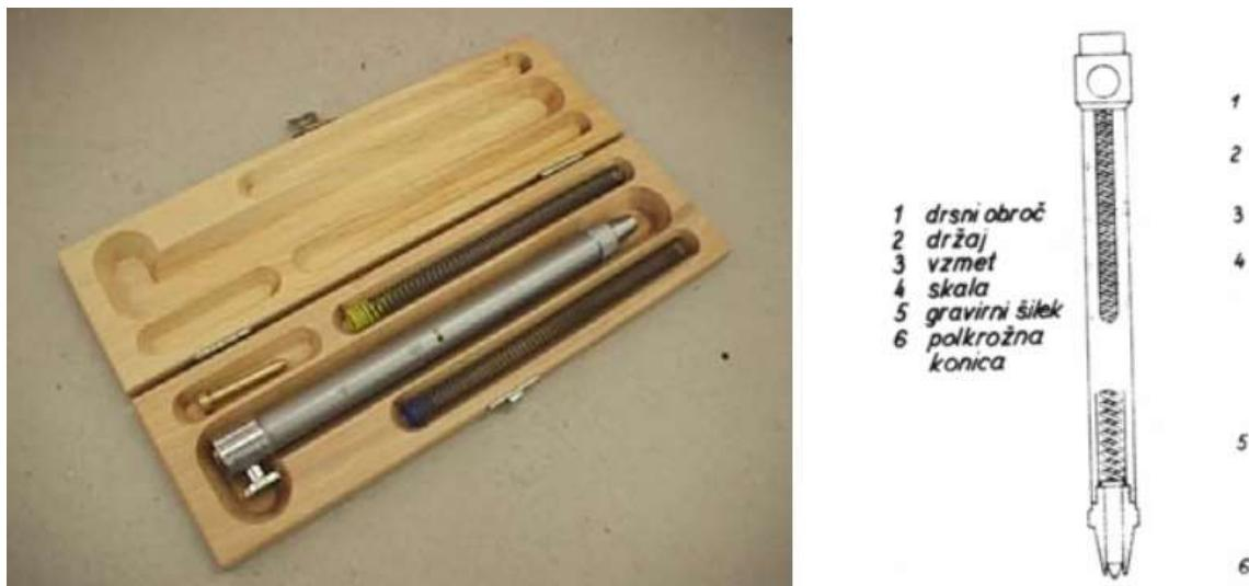
Slika 22: Svinčnik za testiranje odpornosti proti razenju (Pavlič, 2016)
