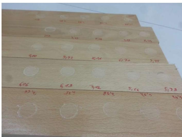
Slika 32: Preizkušanci po že opravljenih meritvah določanja oprijemnosti
