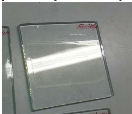
Slika 16: Enakomerno debel, gladek in utrjen film pripravka s silanizirano smolo 98 brez dodanega silana
