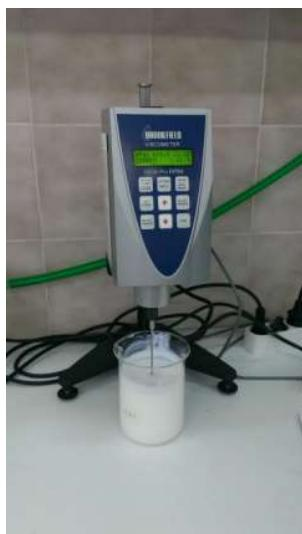
Slika 8: Merjenje viskoznosti z viskozimetrom
