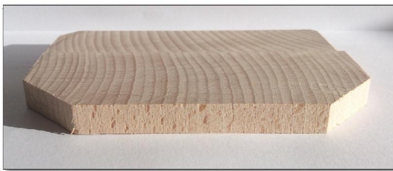
Slika 34 : Preizkušanec; prsni kot  $40^\circ$ , usmeritev  $90^\circ$ , debelina odreza 0,1 mm
