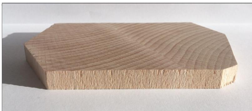
Slika 33 : Preizkušanec; prsni kot  $10^\circ$ , usmeritev  $30^\circ$ , debelina odreza 0,1 mm
