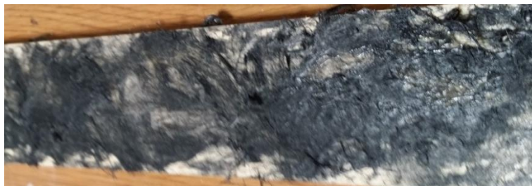
Slika 27: Ogljikova vlakna v kombinaciji s PUR
