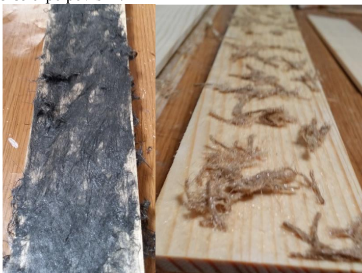
Slika 17: Levo: sintetična razpršena vlakna, desno: skupki naravnih vlaken
