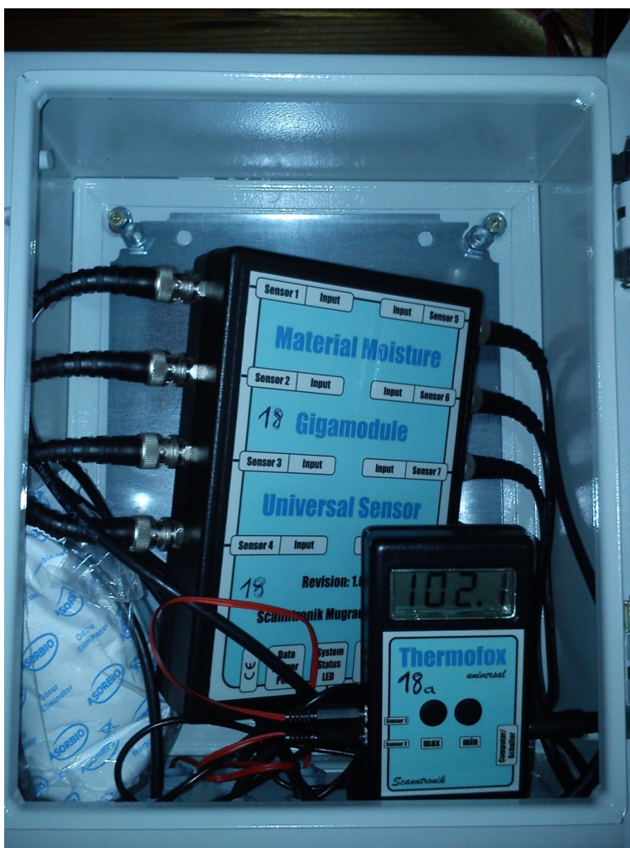
Slika 11: Scantronik Thermofox in Gigamodule v jekleni škatli na mestu merjenja. Poleg merilne tehnike se nahaja silikagel, ki preprečuje poškodbe naprav zaradi kondenzacije vode.
