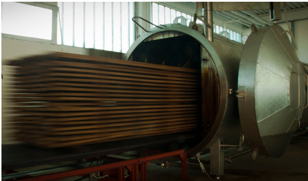
Slika 6: Komora za termično modifikacijo lesa (Silvaprodukt, 2012)
