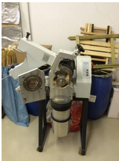
Slika 6: Laboratorijski mlin Retsch SM 2000 (Foto: Kidrič, J., 2015)
