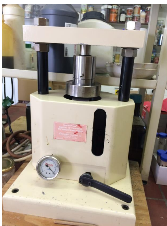
Slika 8: Ročna hidravlična stiskalnica Chemplex (Foto: Kidrič, J., 2015)
