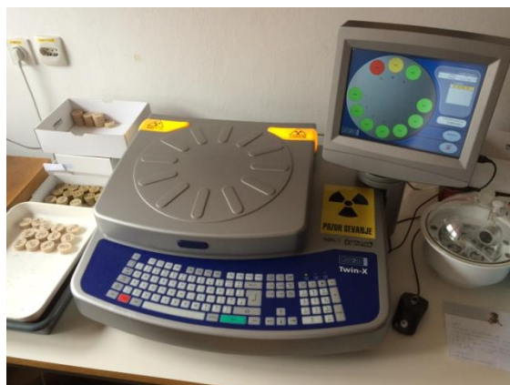
Slika 10: Rentgenski fluorescenčni spektrometer – XRF (Foto: Kidrič, J., 2015)
