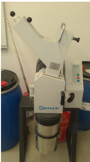
Slika 13: Mlin Retsch SM 2000 (foto: Štefan Kokelj).
