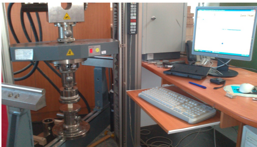
Slika 15: Preizkus tlačne trdnosti vzorcev na Univerzalnem testirnem stroju Zwick-Roell Z100 (foto: Štefan Kokelj).
