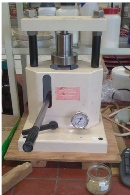
Slika 14: Nastajanje vzorcev (tabletk) v laboratorijski stiskalnici Chemplex Spectro pellet press (foto: Štefan Kokelj).
