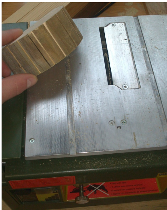
Slika 11: Žagalni stroj Proxxon FKS/e in zareze v kolobarje (foto: Štefan Kokelj).
