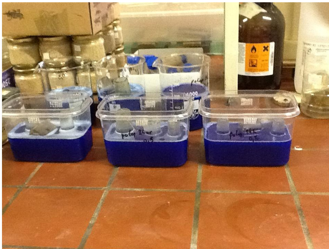
Slika 5: Vzorci, potopljani v impregnacijskem sredstvu Silvanolin.
