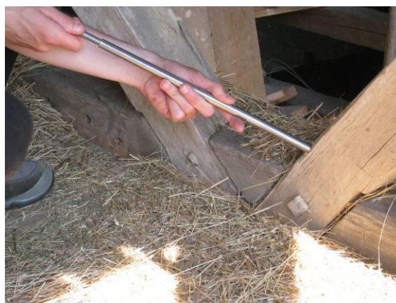
Slika 5: Izvlek izvrtka iz izvrtine.
