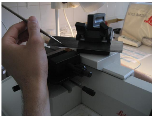
Slika 6: Rezanje tkivnih rezin z drsnim mikrotonom Leica SM 2000R.
