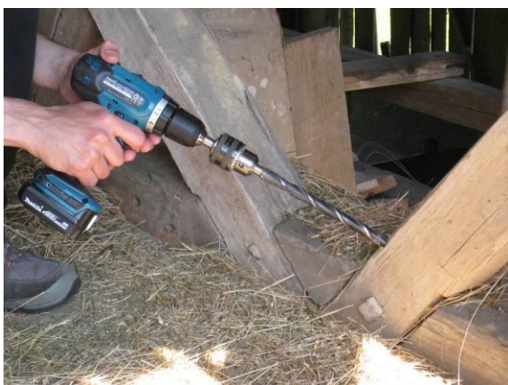
Slika 4: Vrtanje vzorca za izdelavo preparata.
