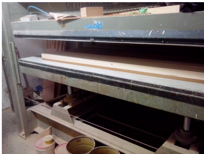
Slika 9: Stiskanje v stiskalnici za ploskovno lepljenje Orma.
