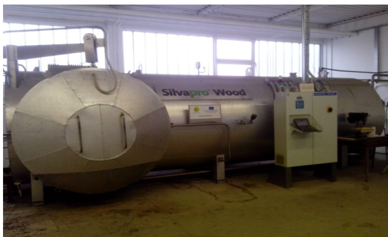
Slika 4: Komora za termično modifikacijo lesa v podjetju Silvaprodukt.
