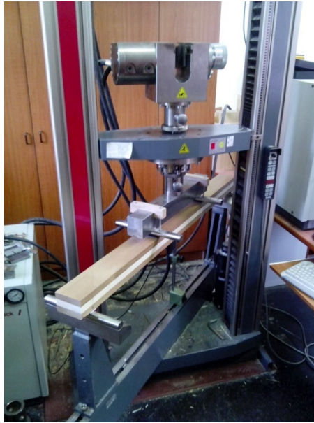
Slika 16: Štiritočkovni preizkus upogibne trdnosti na napravi Zwick Roell Z100.
