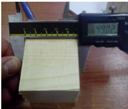
Slika 18: Merjenje višine preizkušanca za strižni test z digitalnim kljunastim merilom.
