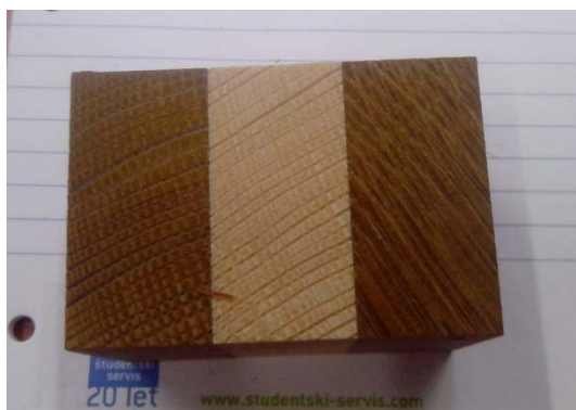
Slika 21: Primer postavitve preizkušanca (pogled z vrha, s smeri pritisnega valja).
