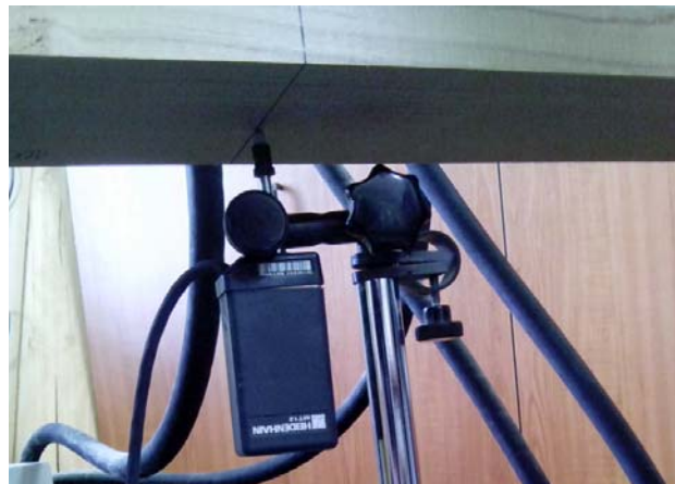
Slika 17: Merilnik Heidenhain MT 12 za merjenje povesa, postavljen na sredino preizkušanca.
