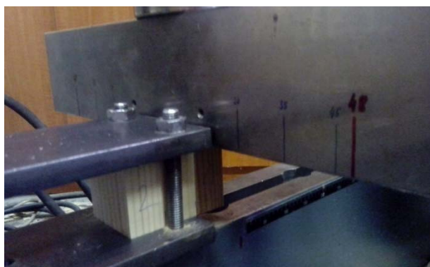
Slika 20: Strižni preizkus na napravi Zwick Roell Z100.
