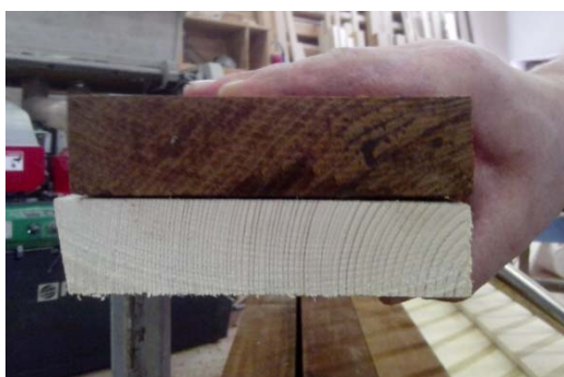
Slika 5: Primer spremembe dimenzij in barve lesa pri termični modifikaciji po postopku Silvapro Wood.
