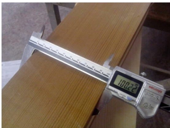
Slika 13: Merjenje širine z digitalnim kljunastim merilom.
