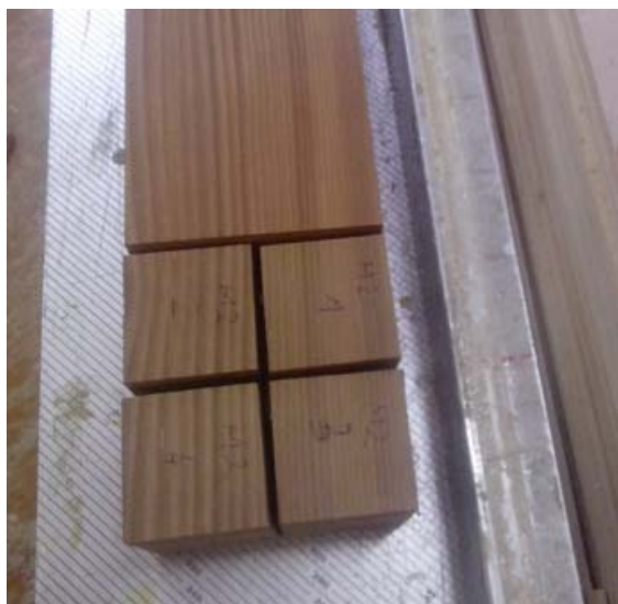
Slika 11: Primer izdelave in označevanja strižnih preizkušancev (zgoraj od desne proti levi 1. in 2. preizkušanec, spodaj od desne proti levi pa 3. in 4. preizkušanec).
