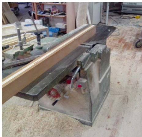
Slika 10: Skobljanje lepljencev na kombiniranem poravnalno-debelinskem skobeljnem stroju SCM Linvincibile 2000d.
