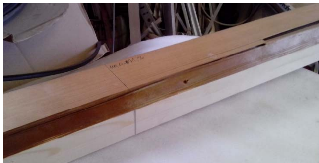
Slika 43: Prelom po braniki (ugoden potek vlaken).
