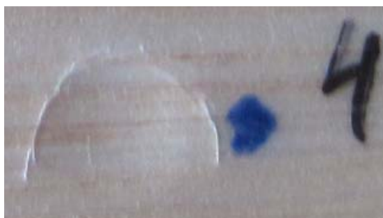
Slika 9: Prikaz poškodbe na mestu in izven mesta udarca
