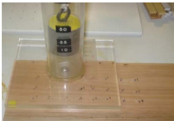
Sliki 5: Prikaz metode določanja odpornosti površinskega sistema proti udarcem
