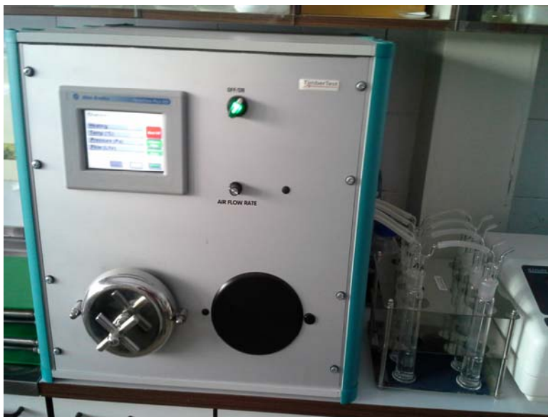
Slika 2: Komora za plinsko analizo s pretočnimi stekleničkami
