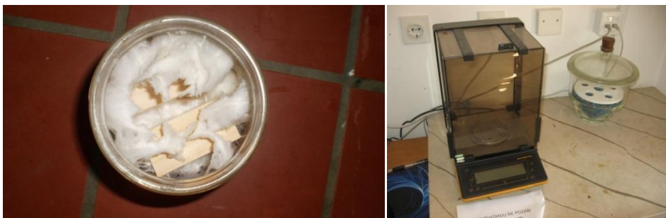
Slika 14: Vzorci po 16 tednih v komori (levo), elektronska tehtnica SARTORIUS (desno)
