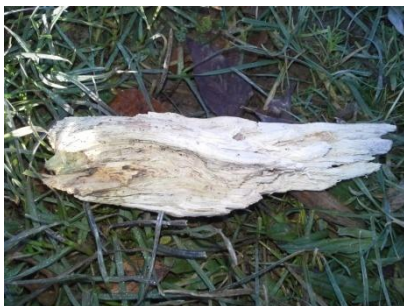
Slika 1: Videz lesa, ki so ga razkrojile glive, povzročiteljice bele trohnobe
