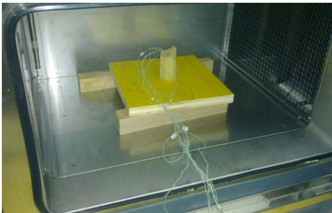
Slika 8. Komora za segrevanje plošč.
