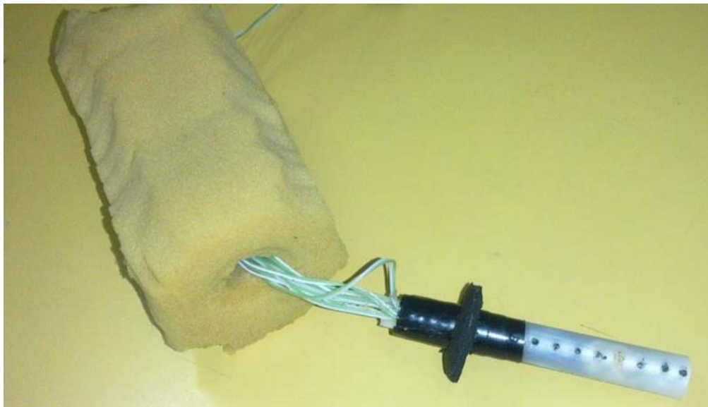
Slika 6. Merilna sonda s termočleni za merjenje temperature pri različnih globinah.
