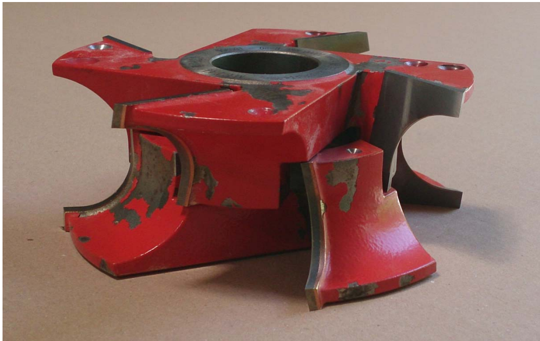
Slika 11: Sestavljen dvodelni profilni rezkar
