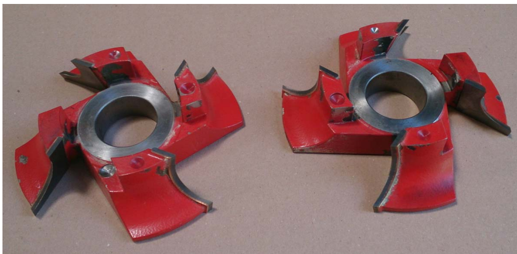
Slika 10: Razstavljen dvodelni profilni rezkar
