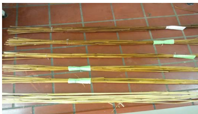
Slika 6: Snopi slame po termični modifikaciji
