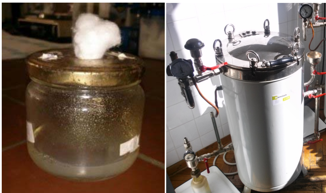
Slika 8: Levo kozarec s svežim hranilnim gojiščem, desno avtoklav
