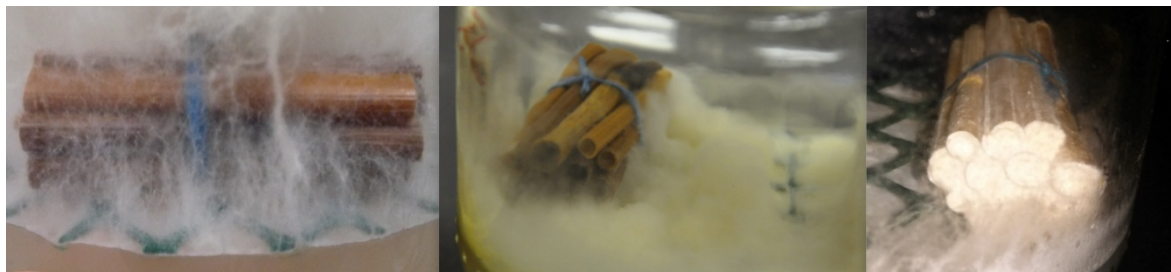
Slika 11: Miceliji gliv od leve proti desni (Bela hišna goba - Pv2, 100%; Navadna tramovka - Gt2, 50%; Pisana ploskocevka - Tv6, 75%)
