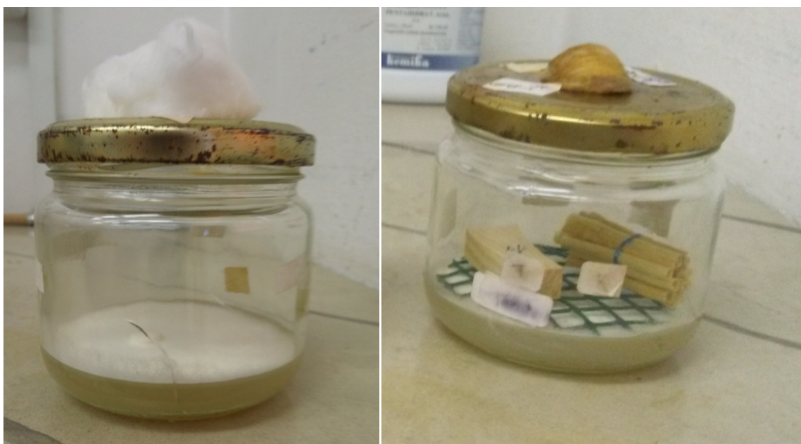
Slika 9: Levo kozarec po enem tednu, desno kozarec z vstavljenim vzorcem lesa in snopičem
