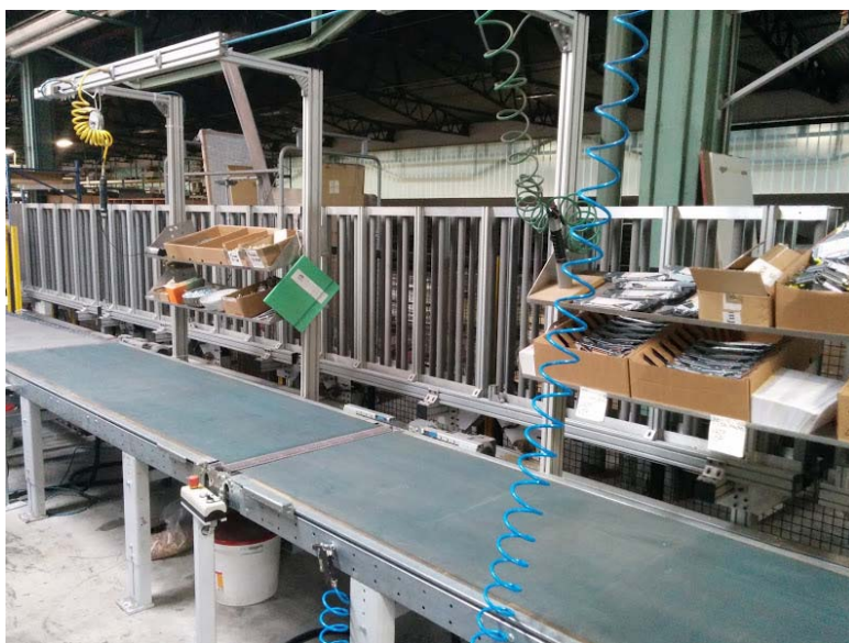
Slika 20: Delovno mesta lepljenja in opremljanja stranic
