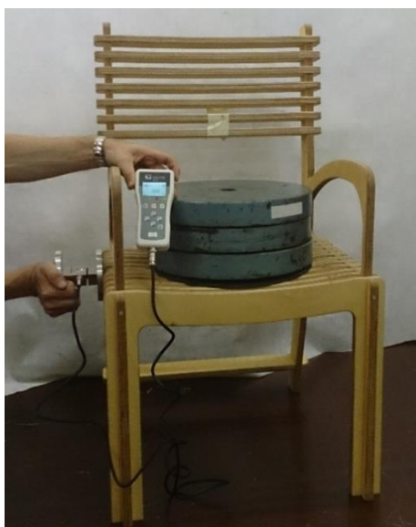
Slika 43: Statična obremenitev nog vstran (foto: Novak)
