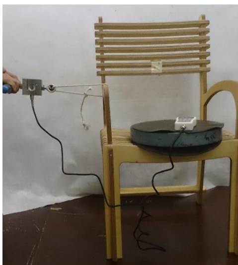
Slika 41: Statična obremenitev naslonjal za roke v horizontalni smeri (foto: Novak)
