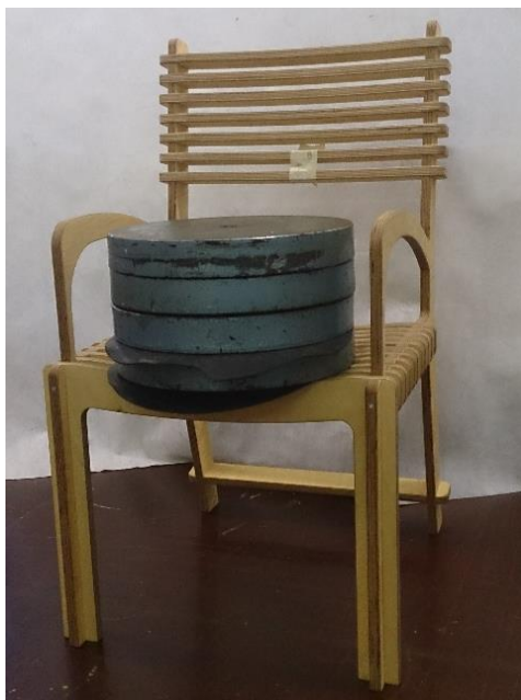
Slika 40: Statična obremenitev sprednjega dela sedežne površine (foto: Novak)
