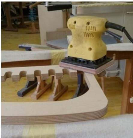
Slika 28: Ročno brušenje z ročnim brusilnim strojem (foto: Novak)
