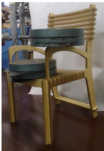
Slika 39: Statična obremenitev naslonjal za roke v vertikalni smeri (foto: Novak)
