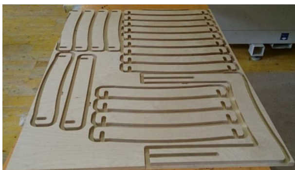
Slika 22: Razporeditev elementov po plošči 1 (foto: Novak)
