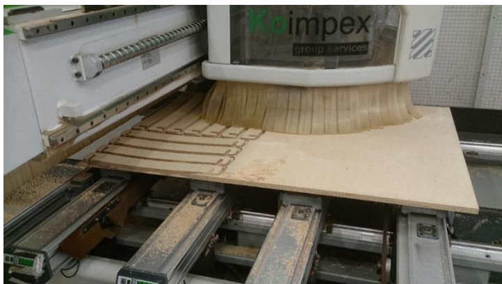
Slika 24: Rezkanje na CNC stroju (foto: Novak)
