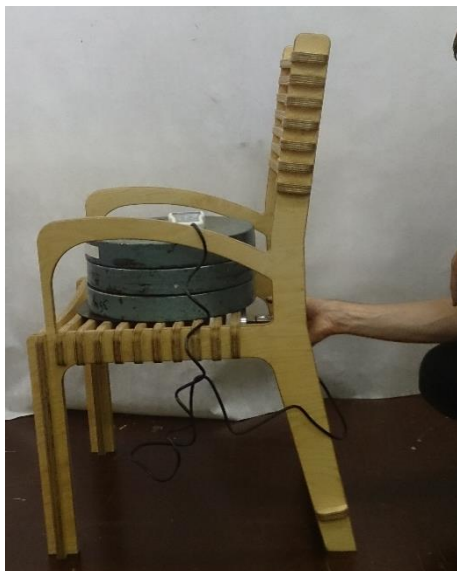
Slika 42: Statična obremenitev nog v smeri naprej (foto: Novak)
