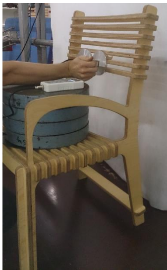
Slika 38: Statična obremenitev sedežne površine in hrbtnega naslona (foto: Novak)
