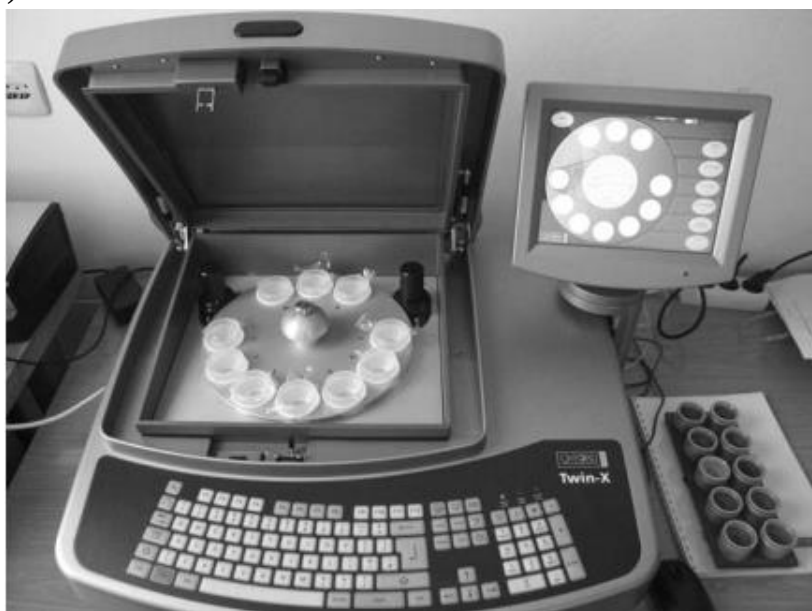
Slika 11: Rentgenski fluorescenčni spektrometer (Humar, 2007)
