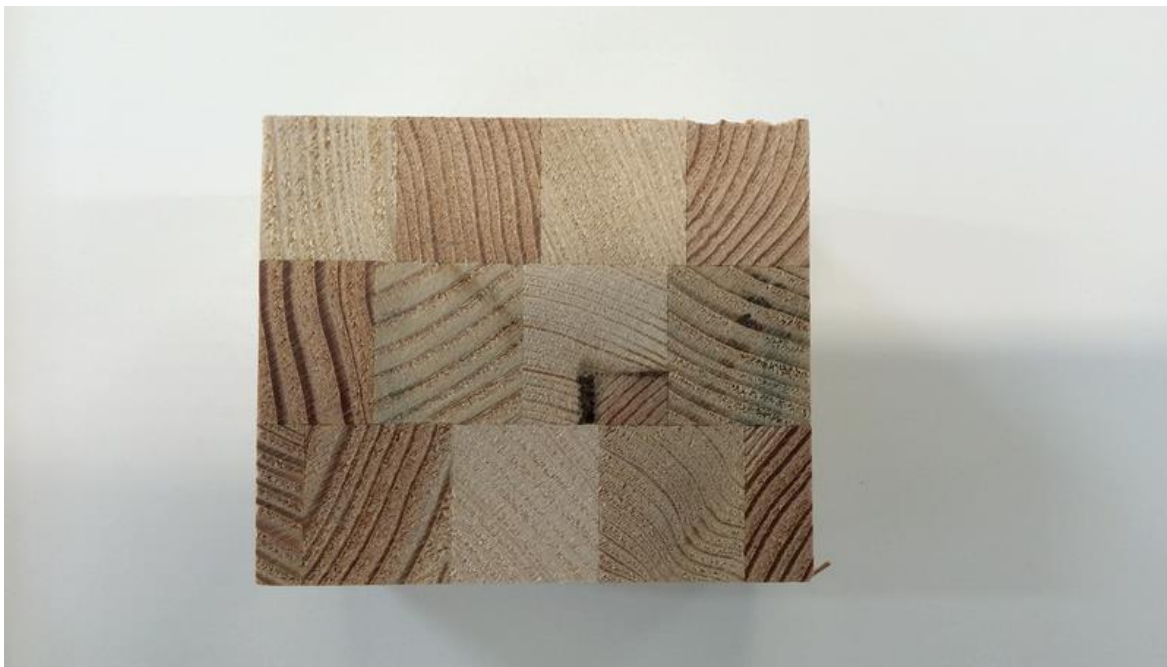
Slika 4: Prerez lepljenca za izdelavo novega okna
