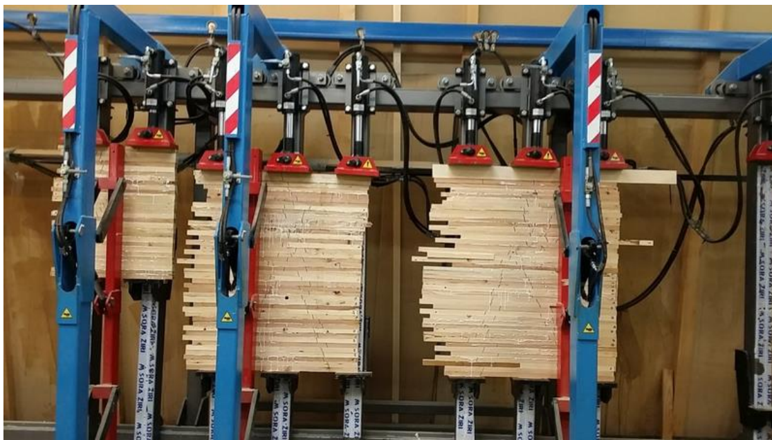
Slika 8: Plošče med stiskanjem
