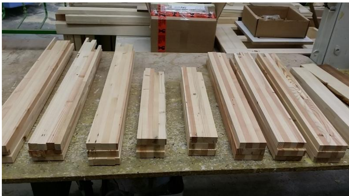
Slika 9: Razžagane deske, pripravljene za lepljenje v lepljenje
