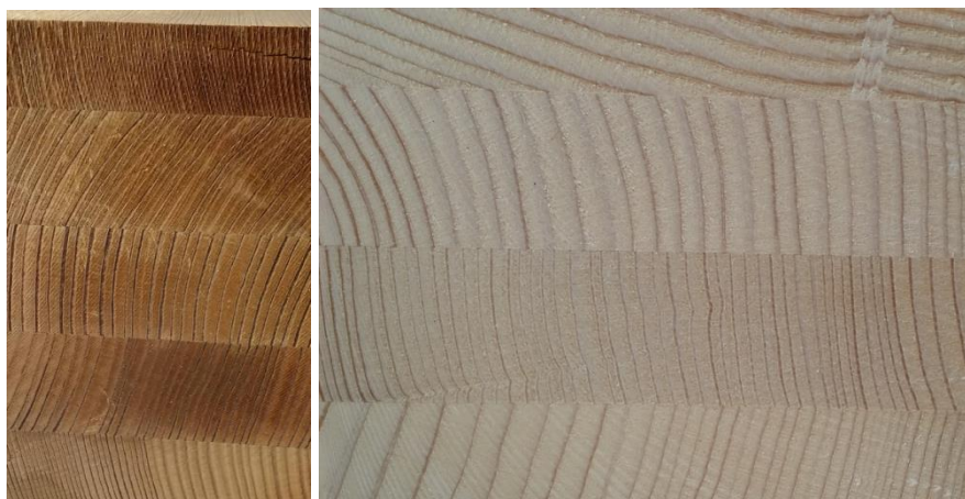
Slika 3: Prerez lepljenca iz termično modificirane (levo) in navadne smrekovine (desno)
