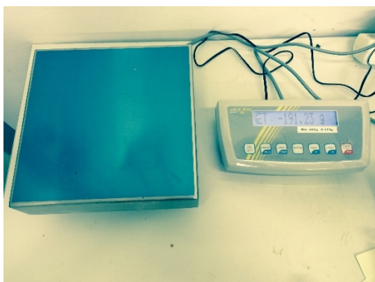
Slika 10: Tehtnica za tehtanje lepilne mešanice
