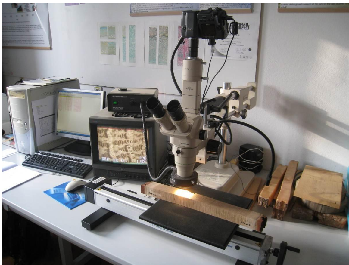
Slika 4: Merilne naprave (računalnik, monitor, fotoaparat, mikroskop, merilna mizica) (foto: Pestotnik)
