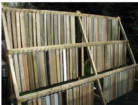
Slika 5: Terenski test naravne odpornosti lesa, kjer se vzorci lahko zelo hitro sušijo (foto: Miha Humar)
