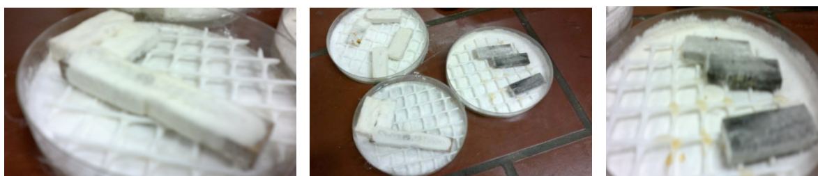
Slika 19: Vzorci lesa, izpostavljeni glivam razkrojevalkam (foto: Matej Pfeifer)
