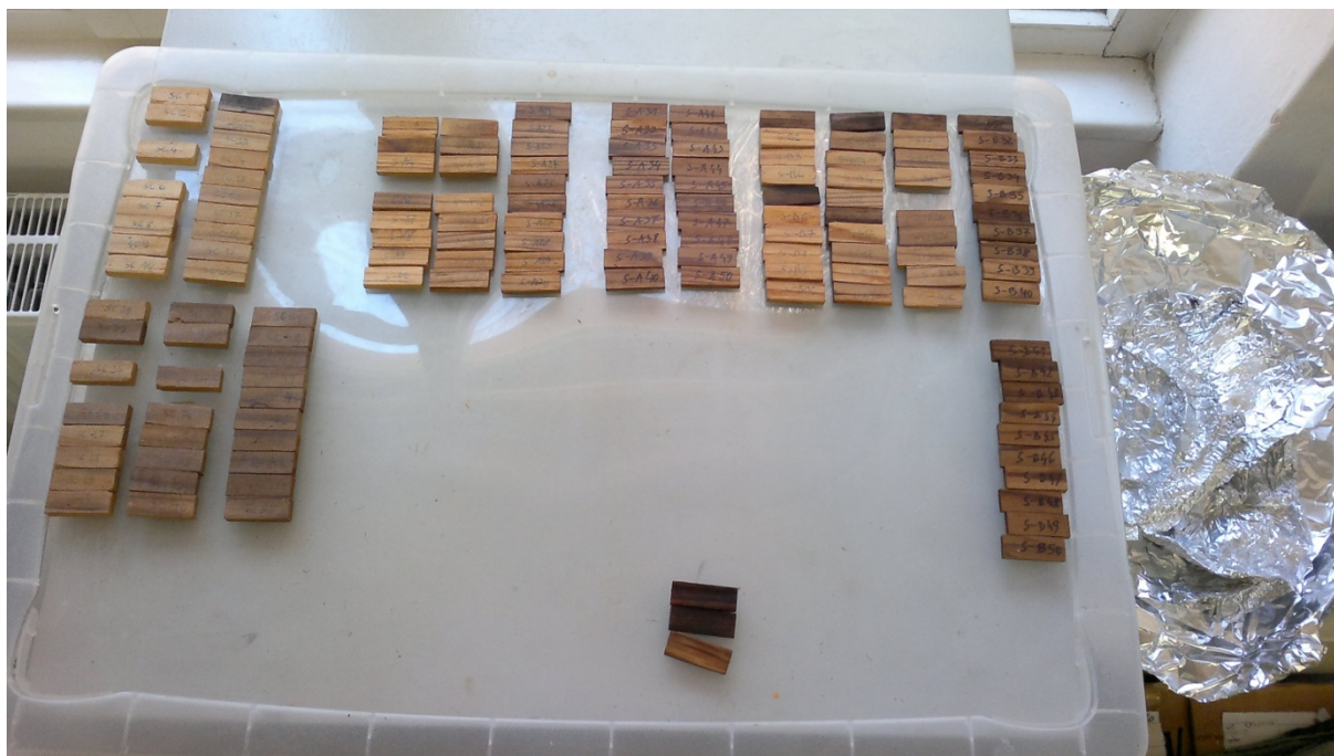
Slika 20: Lesni vzorci po izpostavitvi glivam razkrojevalkam (foto: Matej Pfeifer)
