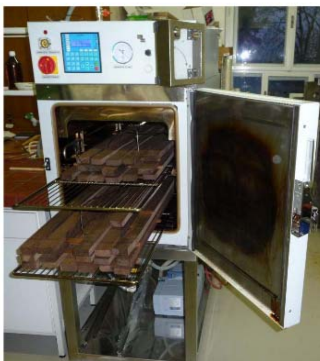
Slika 13: Komora za termično modifikacijo lesa (foto: Franc Pohleven)
