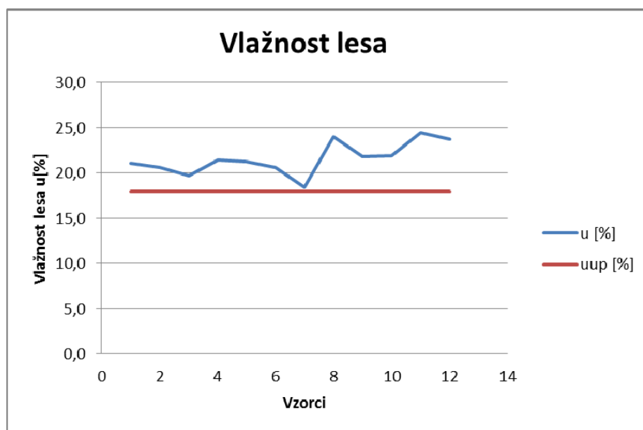
Slika 16: Povprečna vlažnost vzorcev, merjenje s tehtanje vzorcev (u), merjenje z elektro-uporovnim merilnikom (uup)
