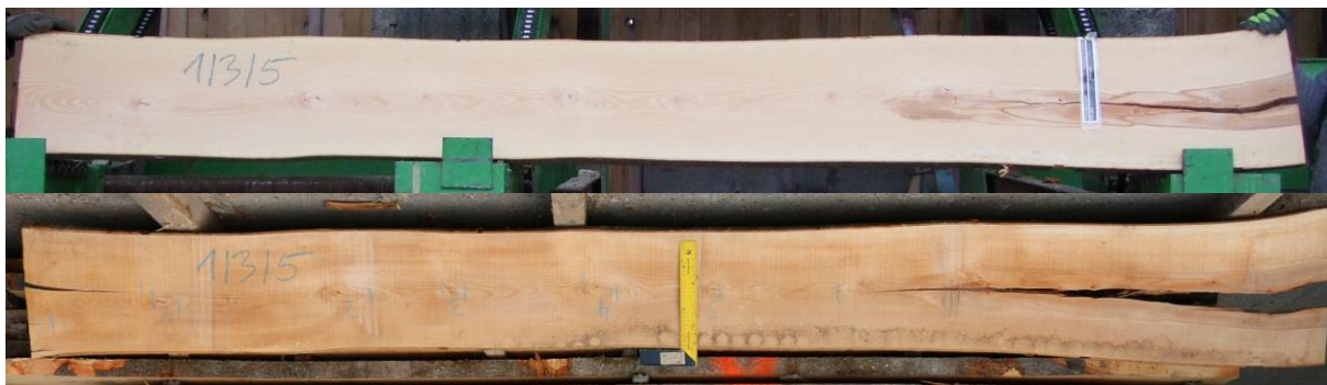
Slika 18: Izgled tipične radialne deske pred (zgoraj) in po postopku sušenja (spodaj)
