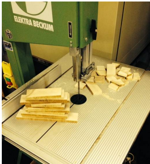
Slika 10: Priprava vzorcev za določanje povprečne vlažnosti lesa
