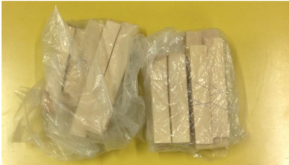
Slika 12: Vzorci za določanje stopnje zaskorjenja lesa po prežagovalni metodi
