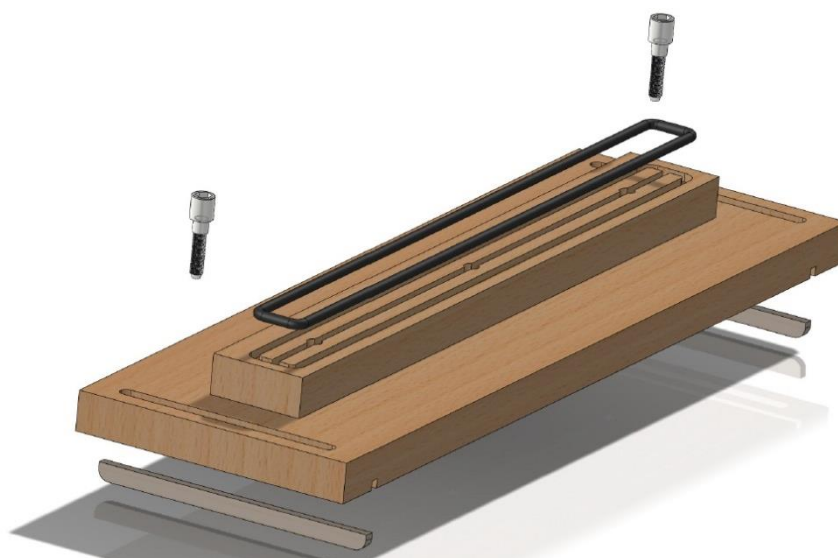
Slika 22: Primer vpenjalne naprave s peresom
