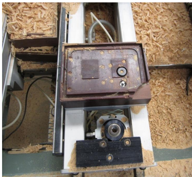
Sliki 11, 12: Primera vakuumskih kladic
