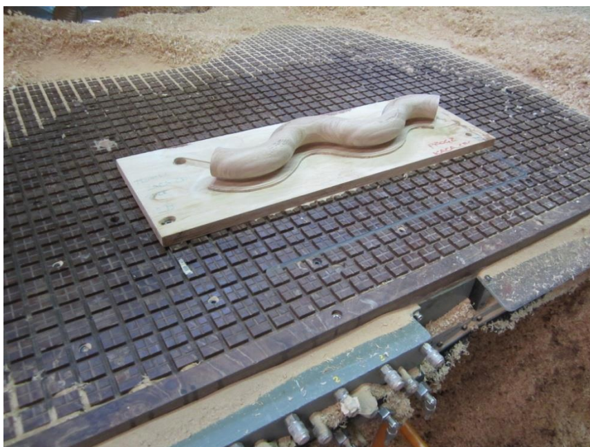
Slika 9: Vakuumska miza s šablono in obdelovancem
