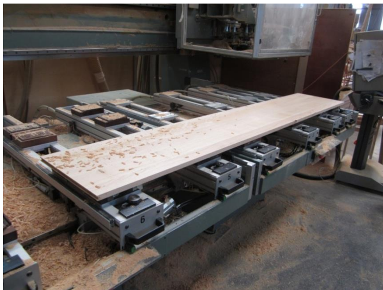
Slika 10: Princip vakuumskega vpetja s pomočjo vpenjalnih kladic
