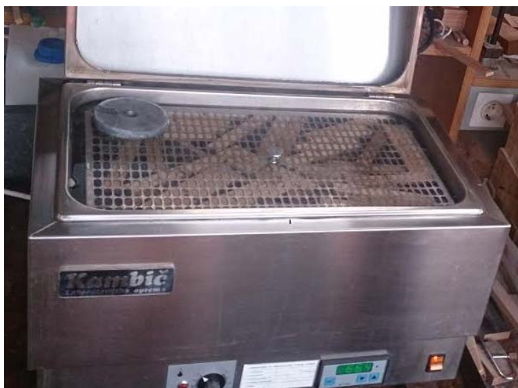
Slika 10: Preizkušanci, ki so bili namočeni 3 h v vodi s temperaturo 67\pm 2\text{ }^{\circ}\text{C}
