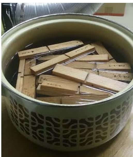
Slika 9: Preizkušanci, ki so bili namočeni 24 h v vodi s temperaturo 20\pm 5^{\circ}\text{C}
