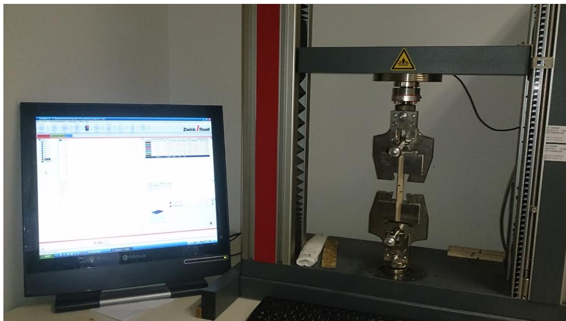
Slika 13: Ugotavljanje strižne trdnosti na testirnem stroju Zwick / Roell 005
