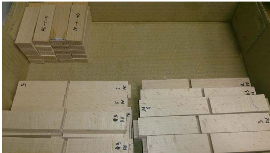
Slika 8: Preizkušanci pripravljeni na testiranje, 10 dni po lepljenju
