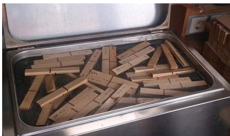
Slika 11: Preizkušanci, ki so bili namočeni 3 h v vodi s temperaturo 67\pm 2\text{ }^{\circ}\text{C} , ob prelaganju v hladno vodo nekateri tudi že razpadejo
