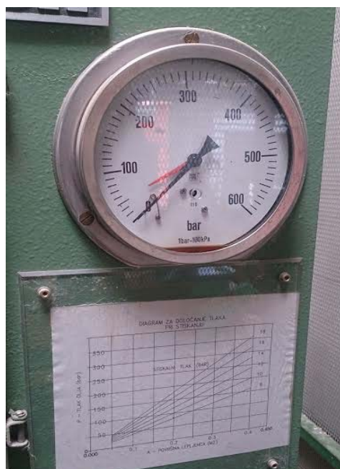
Slika 7: Nastavitev zelenega tlaka na stiskalnici
