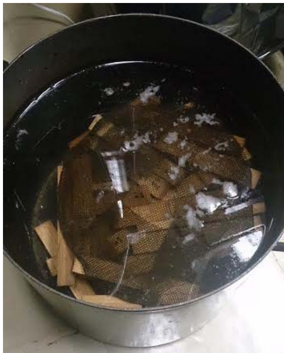
Slika 12: Preizkušanci, ki so bili namočeni 3 h v vreli vodi, veliko jih je že med kuhanjem razpadlo
