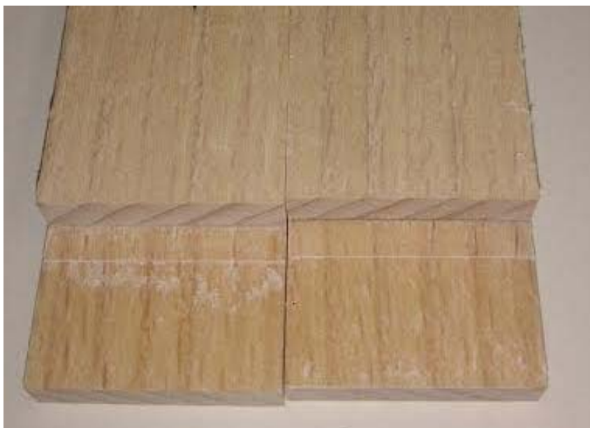
Slika 15: Primer, ko je prišlo do čistega loma po lepilnem spoju (pri večini preizkušancev)
