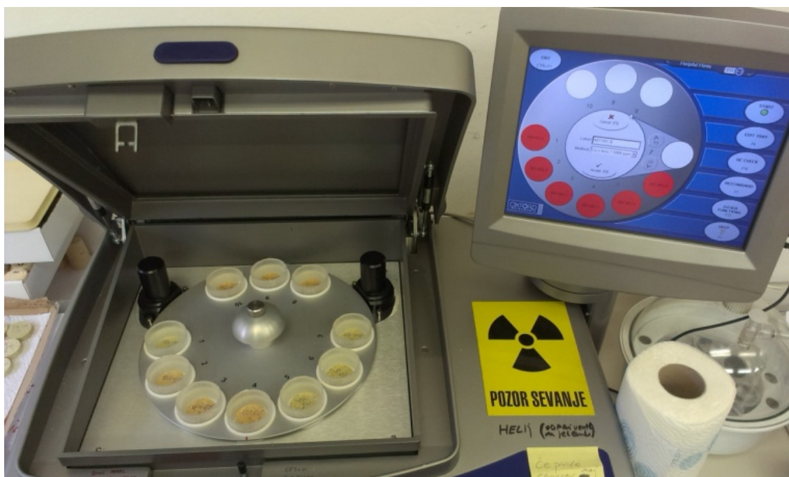
Slika 7: Naprava za XRF analizo vsebnosti bakra v vzorcih
