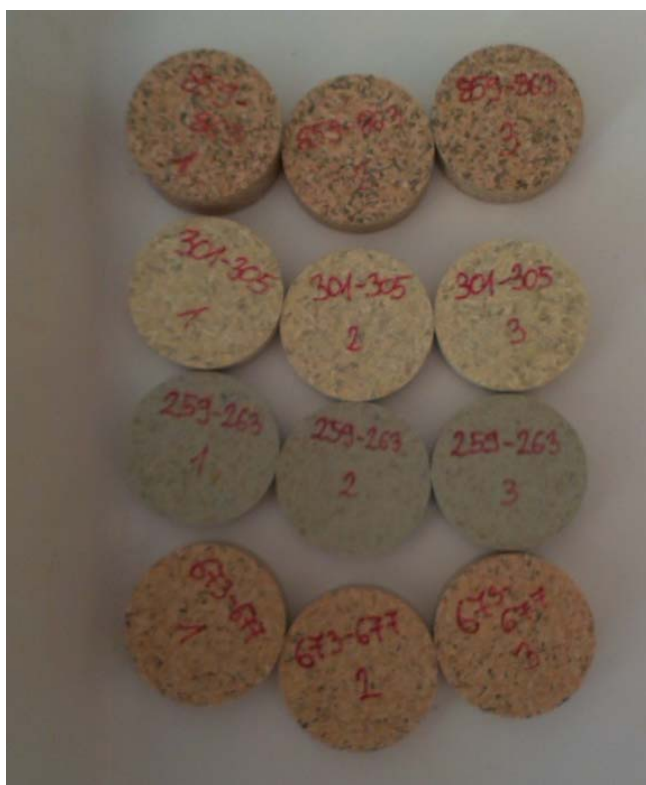
Slika 9: Tablete pripravljene za XRF analizo
