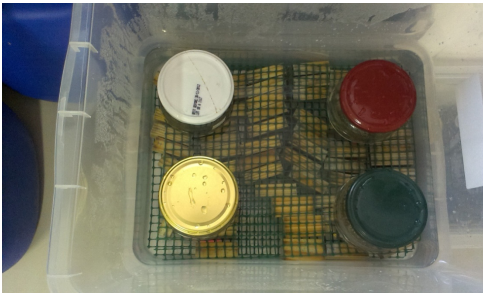
Slika 5: Izpiranje vzorcev v destilirani vodi
