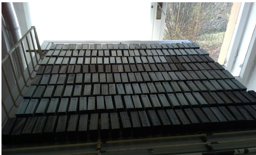
Slika 4: Sušenje impregniranih vzorcev
