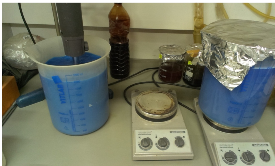
Slika 2: Priprava biocidnega proizvoda na osnovi bakra
