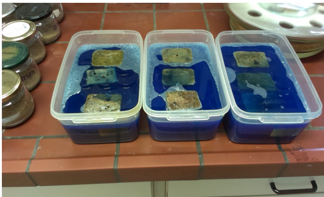
Slika 3: Vzorci med postopkom impregnacije
