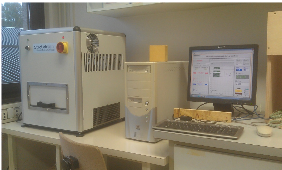
Slika 9: Oprema za preizkušanje toplotne prevodnosti Stirolab
