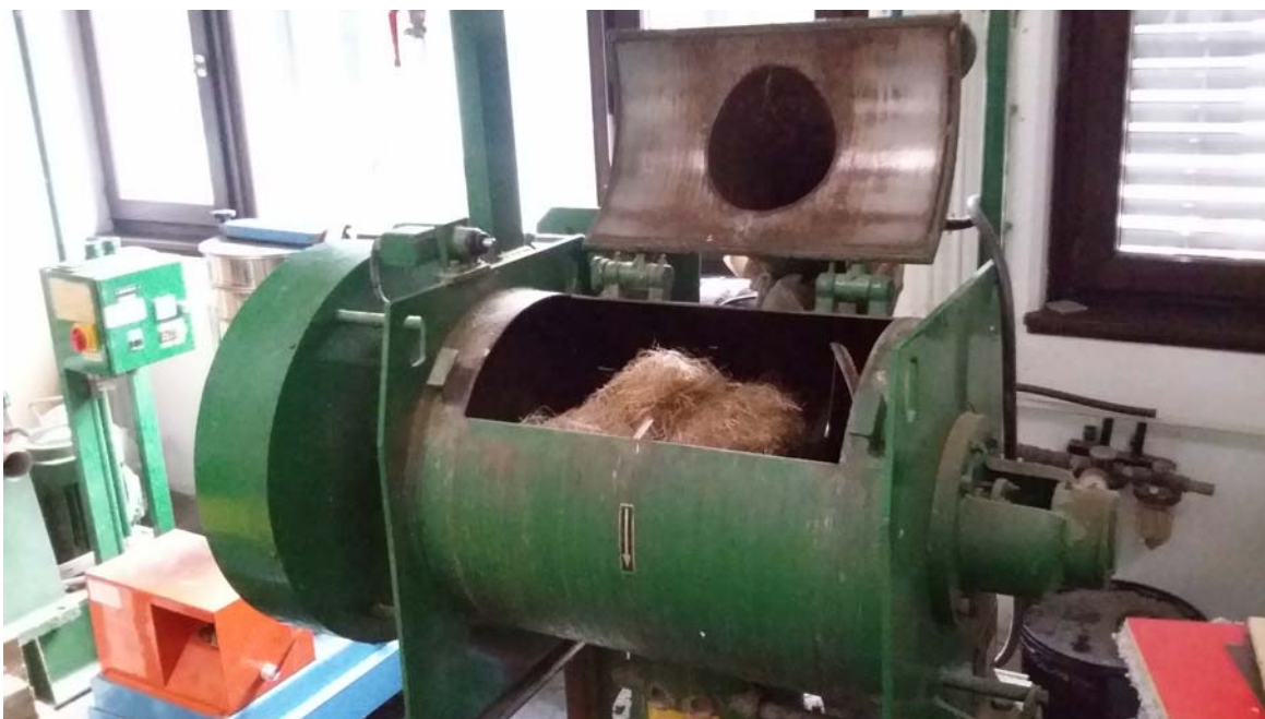
Slika 8: Stroj za oblepljanje iveri in vlaken
