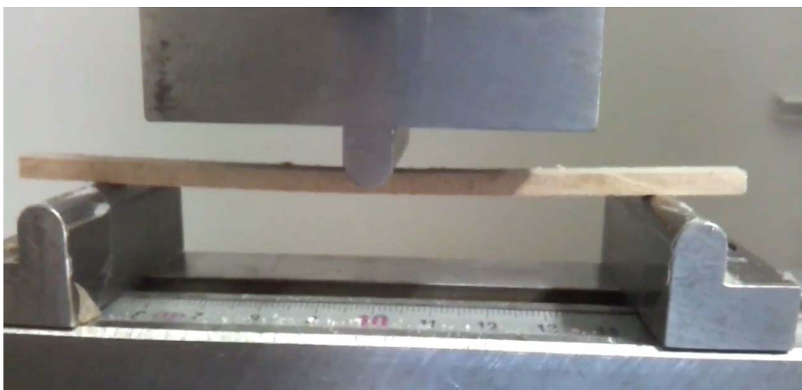
Slika 6: Upogibni test preizkušanca referenčne plošče
