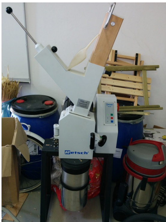
Slika 9: Stroj za fino mletje lesa Retsch SM 2000
