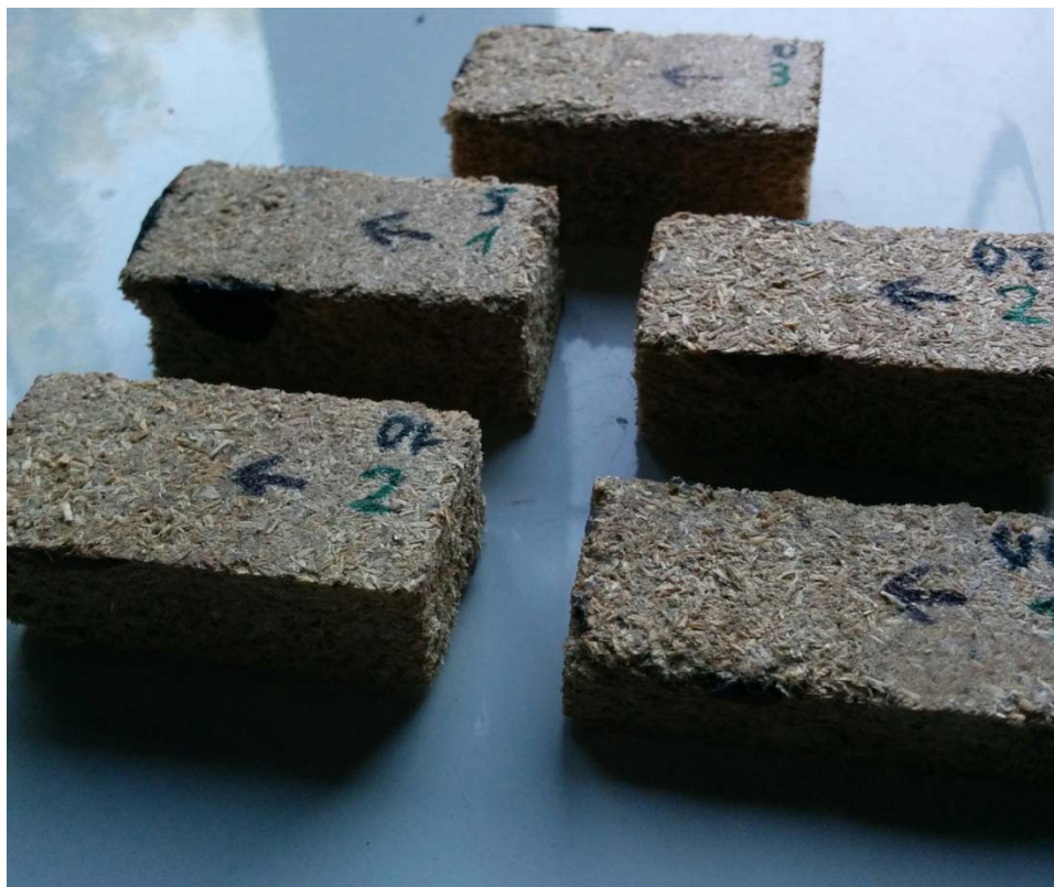
Slika 26: Najbolj poškodovani kompozitni vzorci po izpostavitvi termitom
