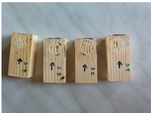
Slika 24: Poškodbe na smrekovih - kontrolnih vzorcih zaradi delovanja termitov
