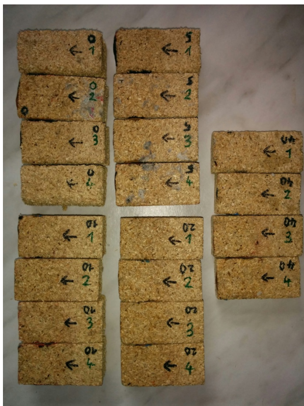
Slika 25: Poškodbe na kompozitnih vzorcih, izdelanih iz stekla in odsluženega lesa
