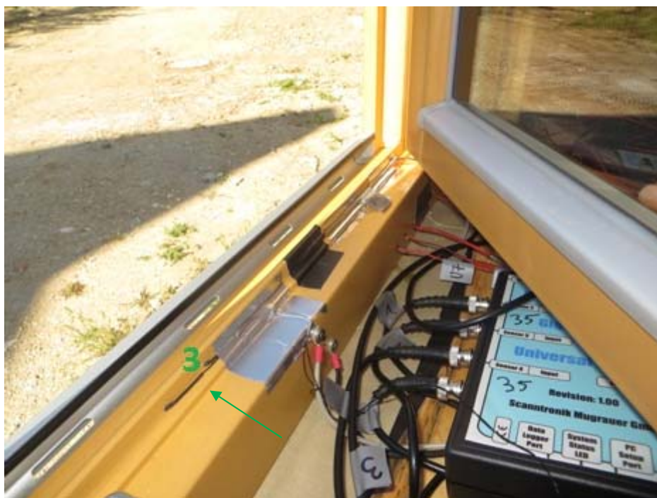
Slika 8: Merilno mesto vlažnosti 3 na oknu 1
