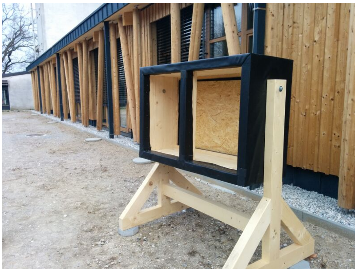
Slika 6: Testni objekt z vgrajenimi okni
