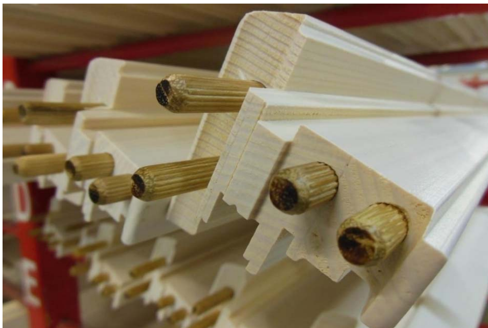
Slika 2: Prikaz površinsko zaščenih čel (Arhiv M SORA, 2015)
