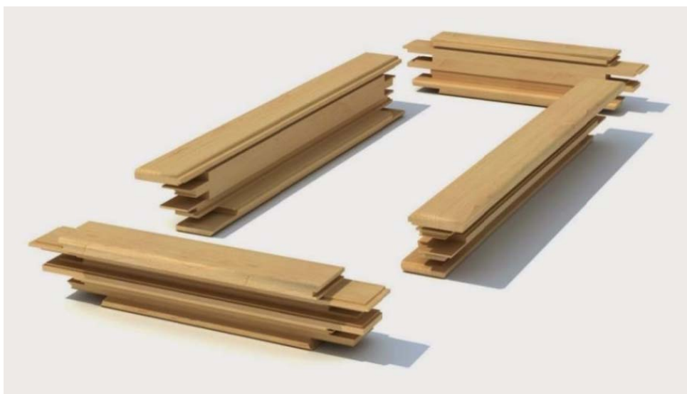
Slika 1: Primer čepne vezi pri sestavi okvirja ( http://thecarpentryway.blogspot.com , 2016)
