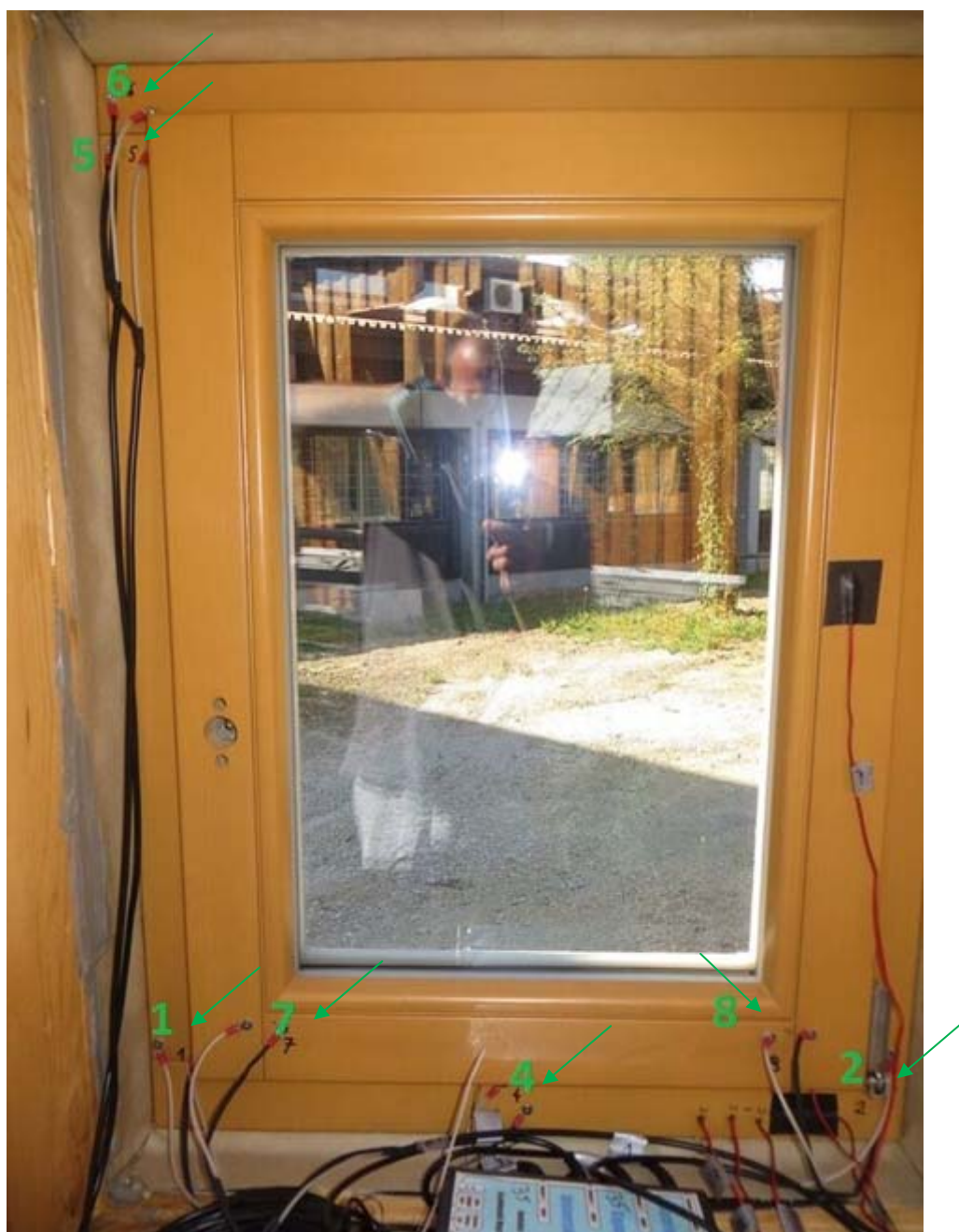
Slika 7: Merilna mesta za vlažnost na oknu 1
