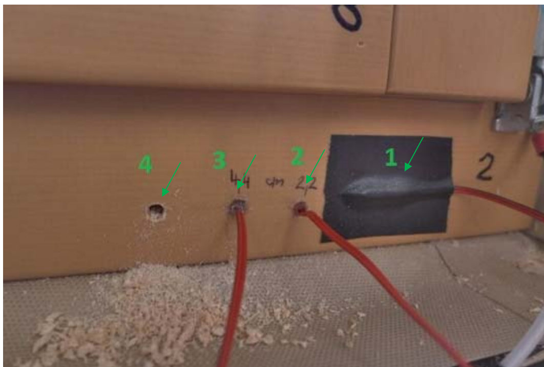
Slika 9: Merilna mesta temperatur na okenskem okvirju
