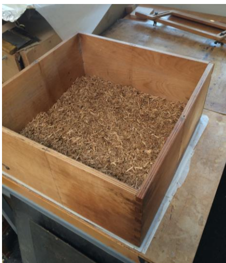
Slika 6: Kalup za izdelavo pogače iverne plošče
