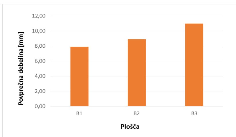
Slika 14: Graf prikazuje povprečno debelino plošč iz grobega iverja
