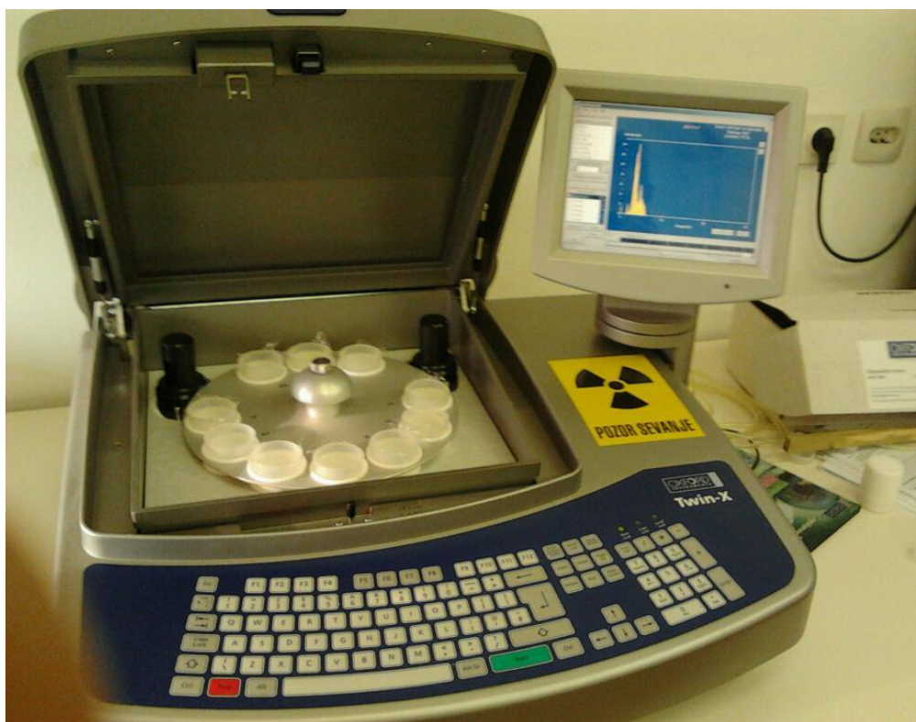
Slika 6: Aparat za rentgensko fluorescenčno spektroskopijo (XRF- Oxford instruments)
