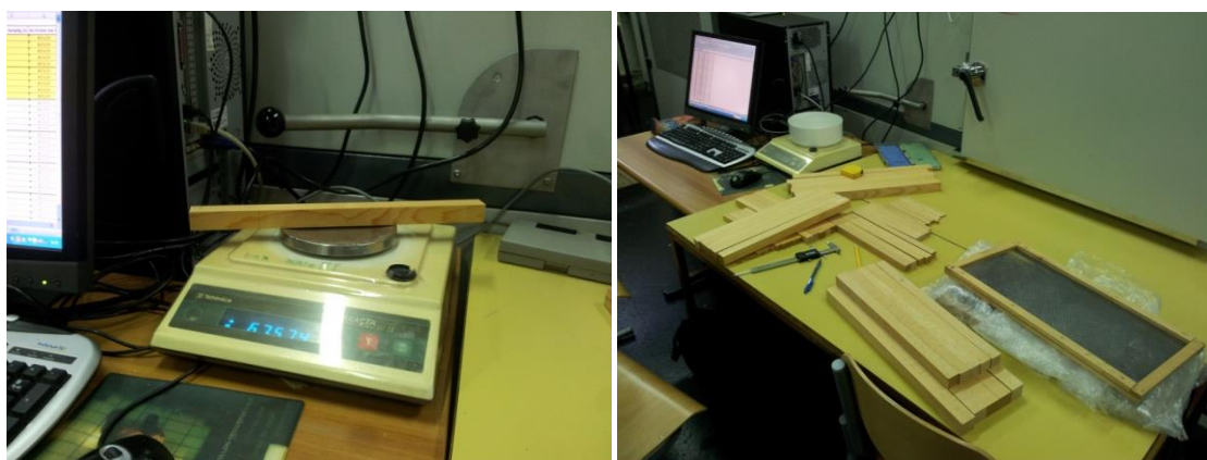
Slika 9: Meritve mase (levo) in dimenzij (desno) preizkušancev
