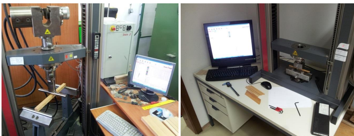
Slika 13: Testirni stroj Zwick Z100 (levo) in Zwick Z005 (desno)
