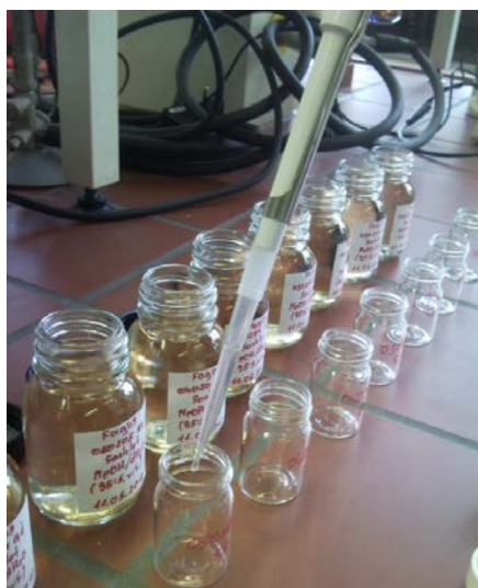
Slika 27: Prenos 0,5 ml vzorca s pipeto v stekleničke, katere smo označili z imeni vzorcev.
