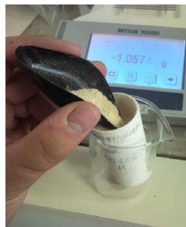
Slika 14: Stresanje že natehtanega vzorca v tulec.
