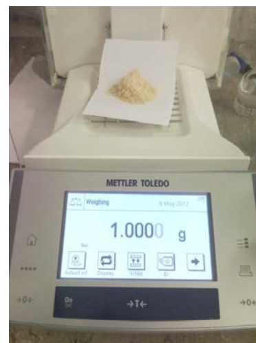
Slika 10: Natresanje in tehtanje vzorca.
