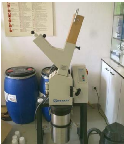
Slika 6: Mlin za mletje Retsch SM 2000.
