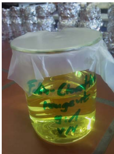
Slika 24: Raztopina FC (Folin – Ciocaltau) v razmerju 1:9 (v/v): 10 ml FC + 90 ml destilirane vode H 2 O.
