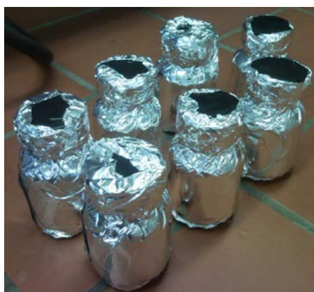
Slika 19: Zaviti vzorci v aluminijasto folijo.
