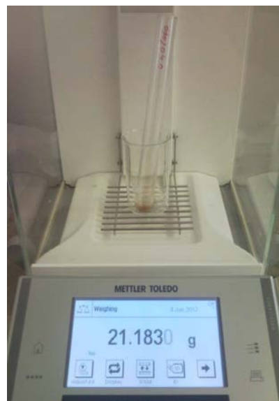
Slika 21: Tehtanje deleža ekstrahiranih snovi.
