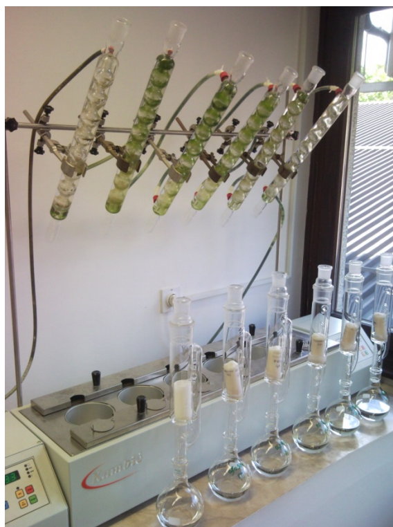
Slika 16: Soxhletov aparat pred ekstrakcijo.
