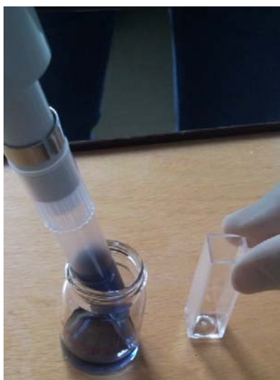
Slika 29: Prenos vzorca 0,5 ml s pipeto v kivete.
