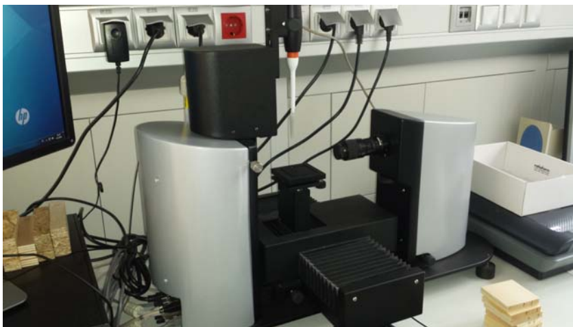
Slika 5: Goniometer »The Theta (Optical Tensiometer) contact angle goniometer« finskega proizvajalca Biolin Scientific
