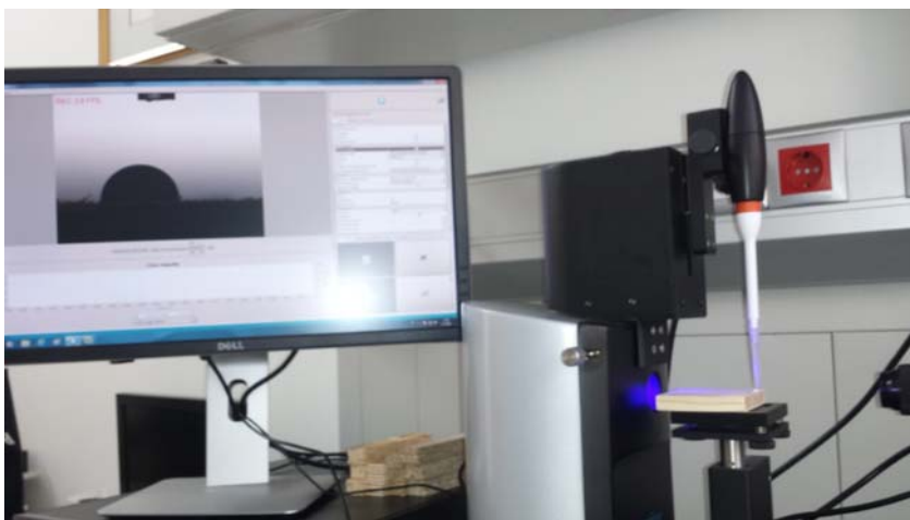
Slika 7: Merjenje kontaktnega kota z goniometrom
