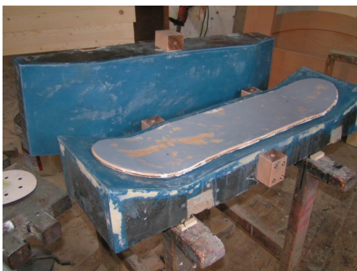
Slika 9: Kalup za izdelavo deske rolke
