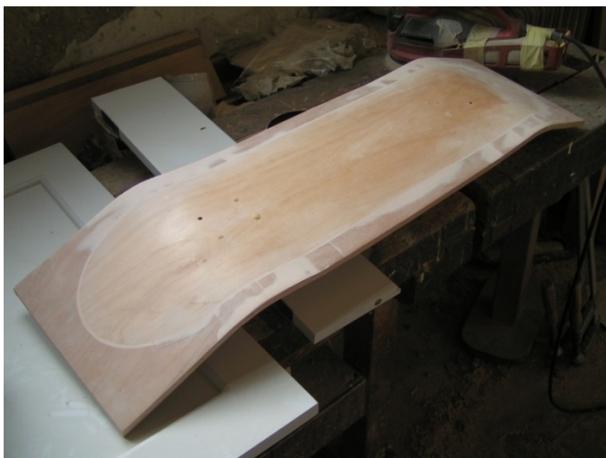
Slika 6: Priprava referenčne deske za izdelavo kalupa
