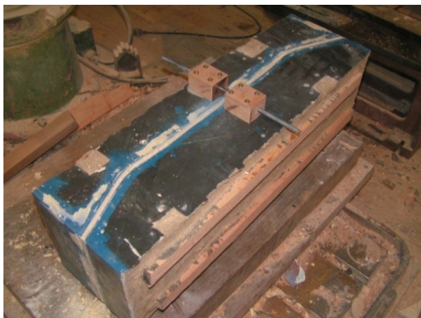
Slika 8: Pritrjevanje centrinih zatičev
