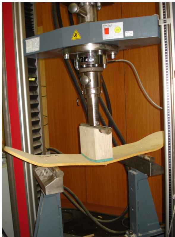
Slika 14: Način upogibne obremenitve deske rolke s testirnim strojem ZWICK Z100
