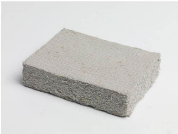
Slika 3: Homatherm flexCL plošča ( Homatherm, 2014 )
