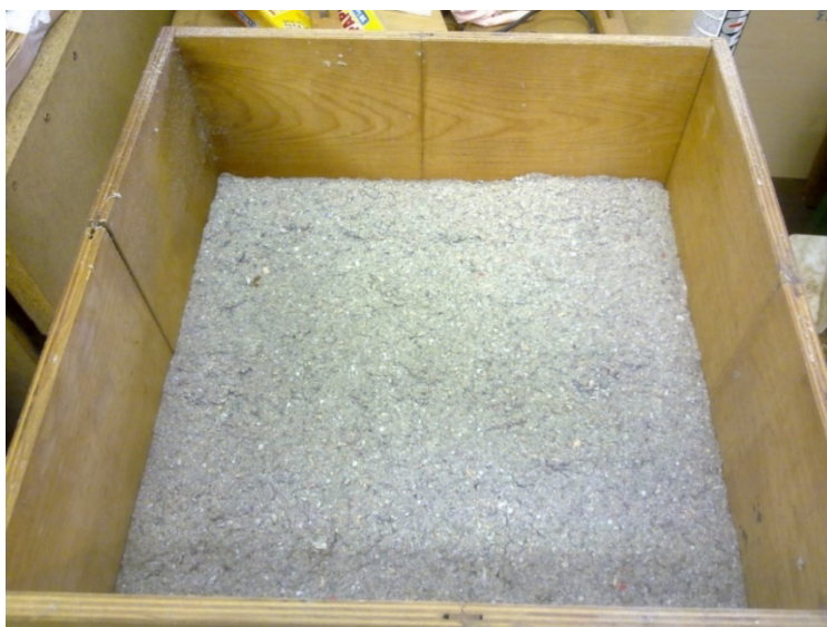
Slika 5: Kalup za pripravo plošč 500x500 mm
