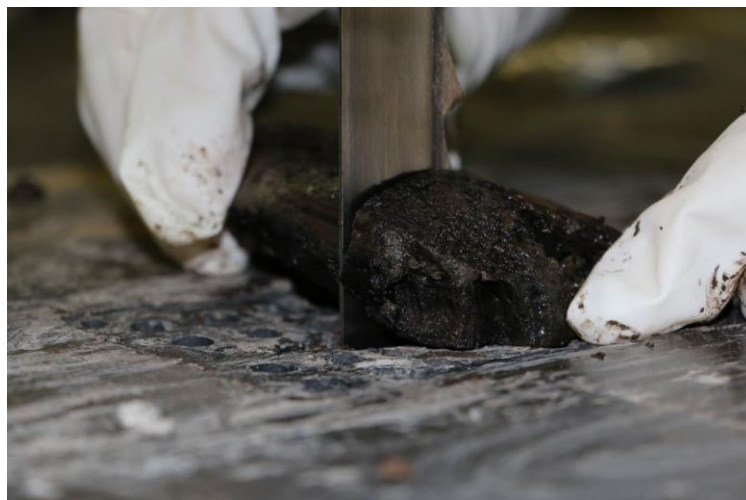
Slika 4: Tračni žagalni stroj, s katerim smo vzorce narezali na kolobarje.
