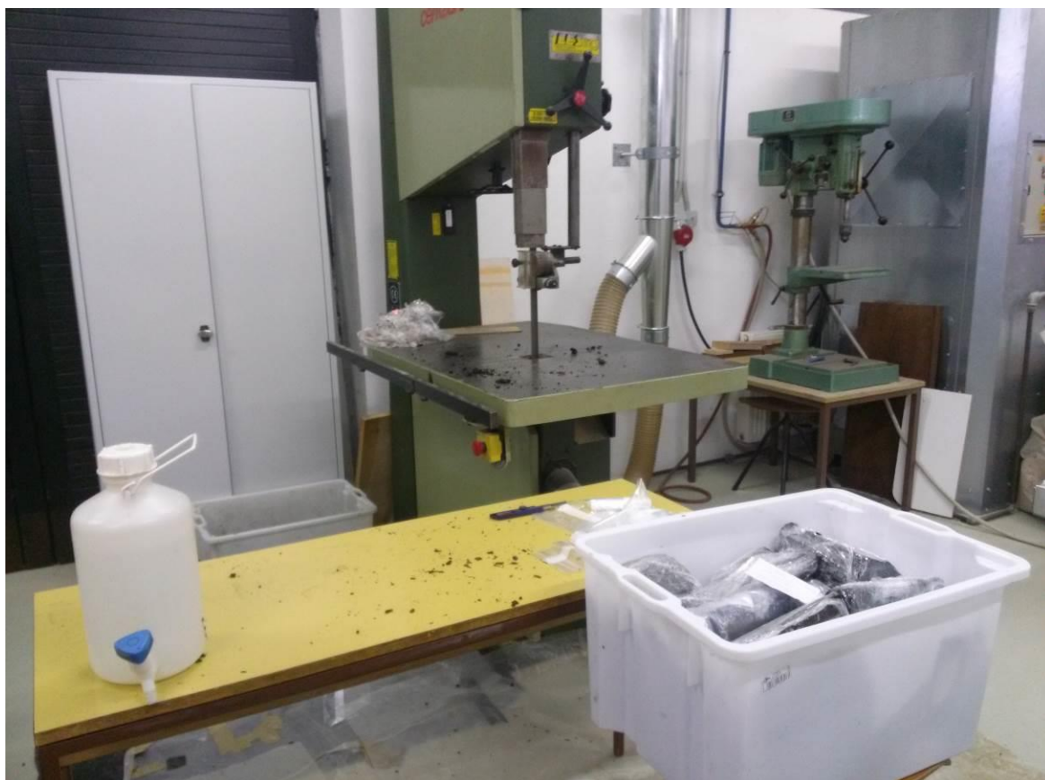
Slika 4: Tračni žagalni stroj, s katerim smo vzorce narezali na kolobarje.
