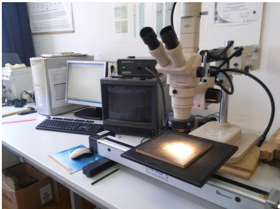
Slika 10: Sistem za izvedbo dendrokronološke raziskave (Olympus SZ-PT).
