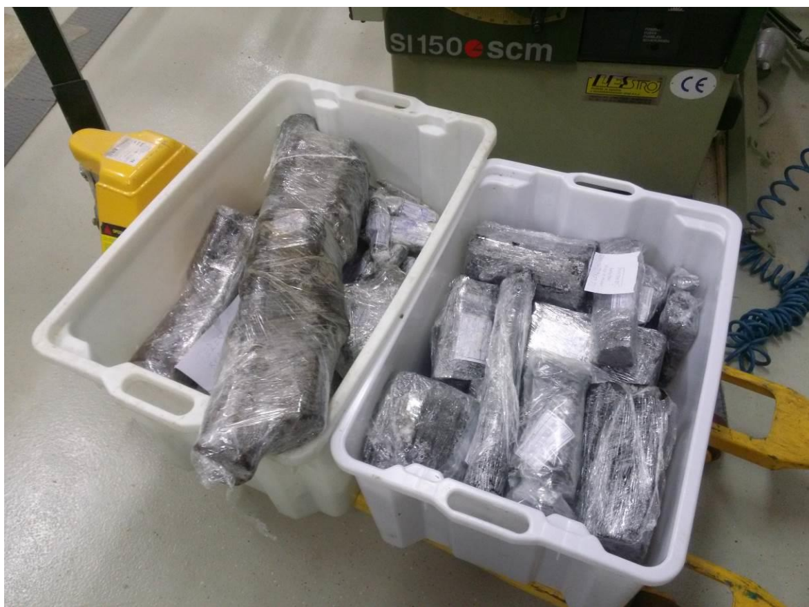
Slika 3: Vzorci lesa po odvzemu na terenu, pripravljeni za obdelavo s tračnim žagalnim strojem. Označeni so z identifikacijskimi številkami in zaviti v polietilensko folijo.
