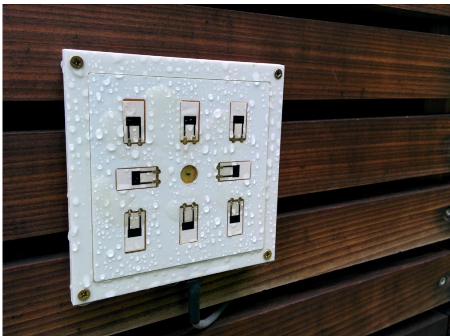
Slika 16: Sistem za spremljanje površinske kondenzacije in sončnega obsevanja (Avtor: Miha Humar)
