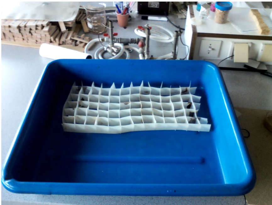
Slika 11: Priprava kadi in modela za namakanje preizkušancev
