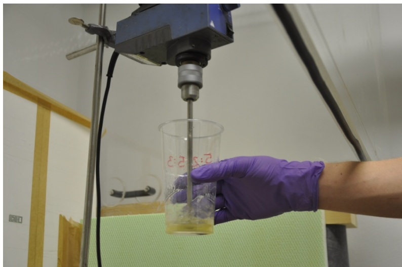
Slika 4: Mešanje furfuril alkohola in glicerola na mešalniku
