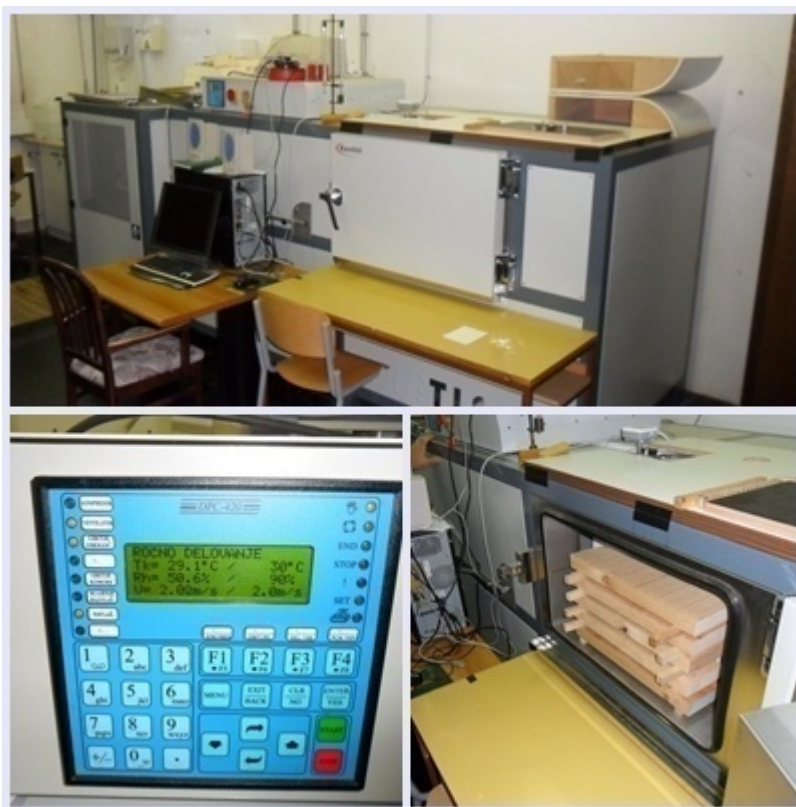
Slika 2: Konvekcijski sušilni kanal TLS-01 (zgoraj) s PLC krmilnikom (sp. levo) in z eksperimentalno komoro (sp. desno).
