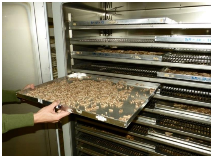
Slika 10: Sušenje vzorca peletov na 105 °C v sušilniku Ehret TK/L
