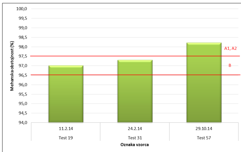
Slika 39: Mehanska obstojnost peletov pri proizvajalcu B, rdeči črti na grafu ponazarjata meji za razvrščanje v kakovostne razrede A1, A2, B
