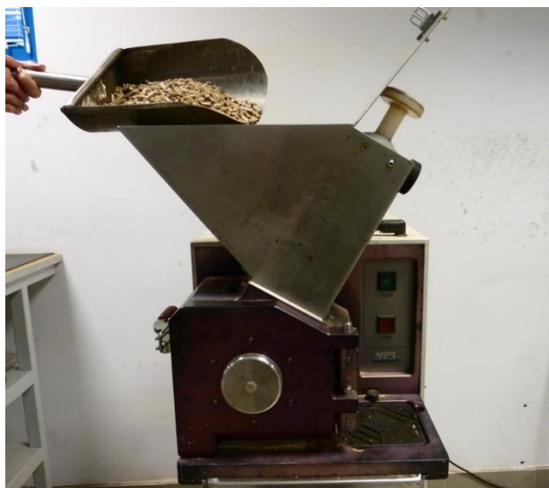
Slika 8: Mletje vzorca peletov na grobem mlinu Pulverisette-25
