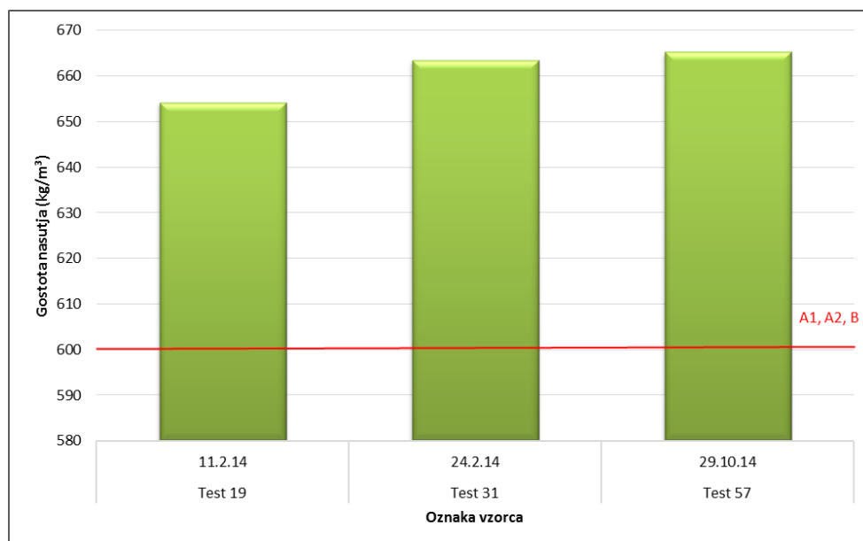
Slika 40: Gostota nasutja vzorcev peletov proizvajalca B, rdeča črta na grafu ponazarja mejo za razvrščanje v kakovostne razrede A1, A2, B
