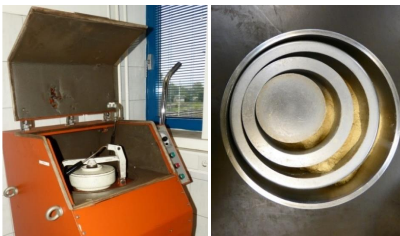
Slika 9: Mletje vzorca na diskastem finem mlinu Pulverisette-9
