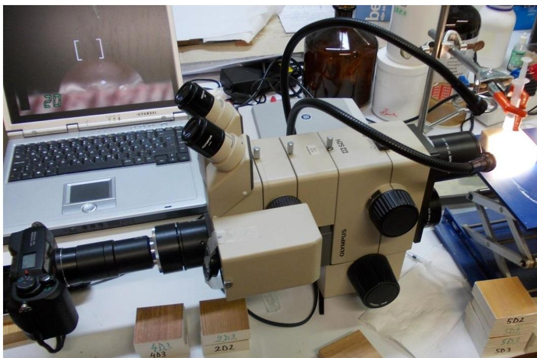
**Slika 9:** Stereomikroskop, povezan s fotoaparatom in računalnikom.
