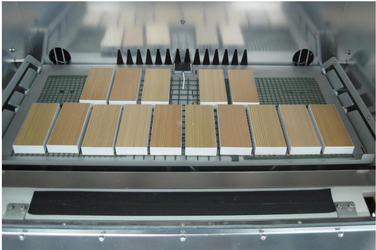
Slika 4: Vzorci v napravi Atlas SUNTEST XXL
