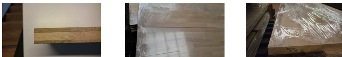
Slika 33: a) Neustrezna debelina zgornjega sloja troslojne plošče b) odprt spoj pri dolžinsko-širinsko lepljeni plošči c) neustrezno pakiranje oz. foliranje
