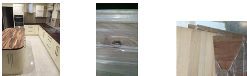
Slika 31: a) Barvna neusklajenost orehovitih kuhinjskih pultov b) grča v prvi lameli hrastove plošče c) barvno neusklajena češnjeva plošča
