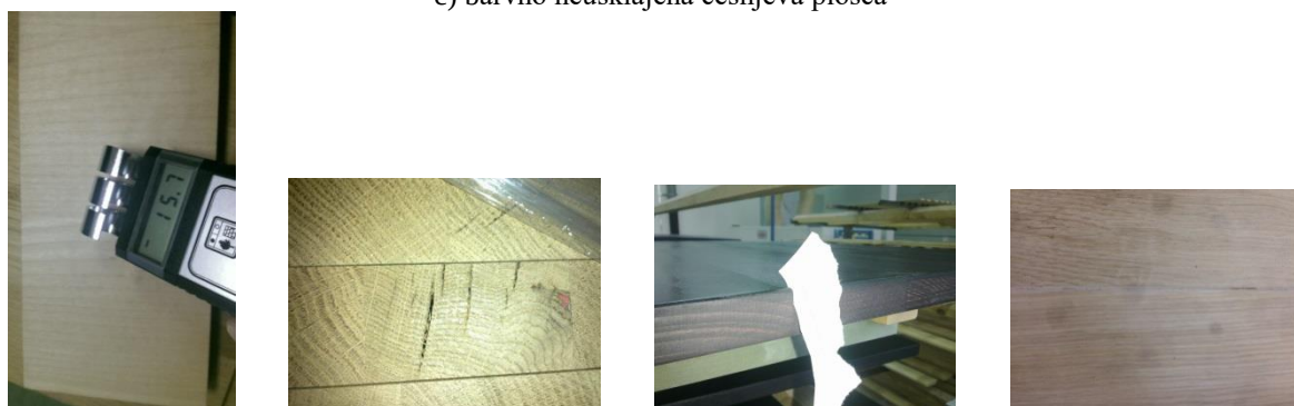
Slika 31: a) Barvna neusklajenost orehovitih kuhinjskih pultov b) grča v prvi lameli hrastove plošče c) barvno neusklajena češnjeva plošča
