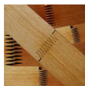
Slika 8: Dolžinski spoj pri dolžinsko-širinsko lepljeni plošči (Keilzinken...,2016)
