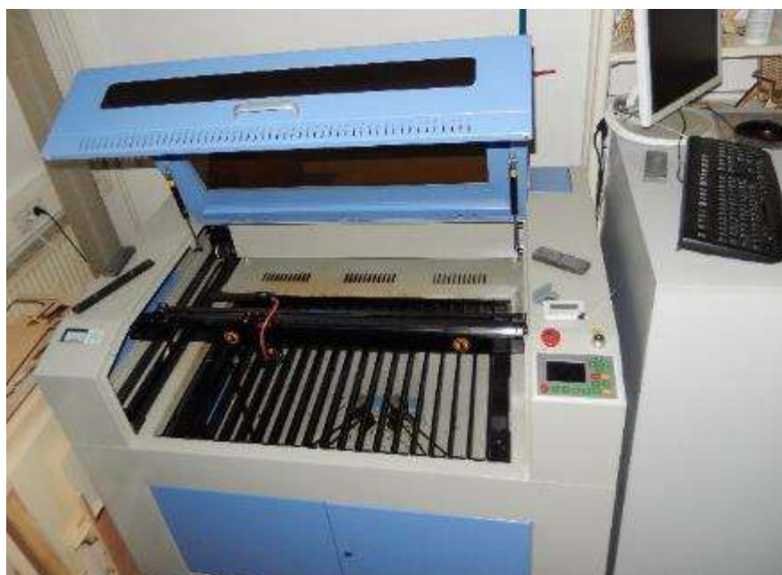
Slika 12: Fotografija CO 2 laserja, uporabljenega pri razrezu furnirnih vezanih plošč (osebni arhiv, maj 2016)
