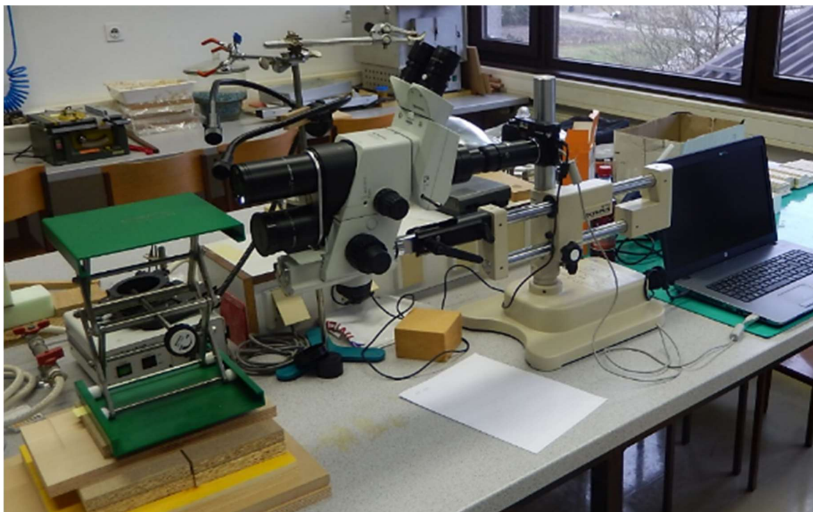
Slika 15: Mikroskop s pomočjo katerega smo poslikali laserske reze v vezani plošči (osebni arhiv, maj 2016)
