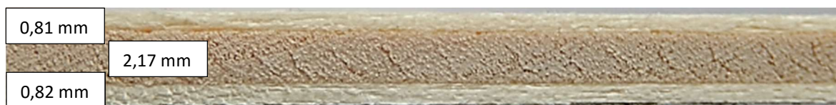
Slika 11: Prerez topolove furnirne vezane plošče nazivne debeline 4 mm (osebni arhiv, julij 2016)
