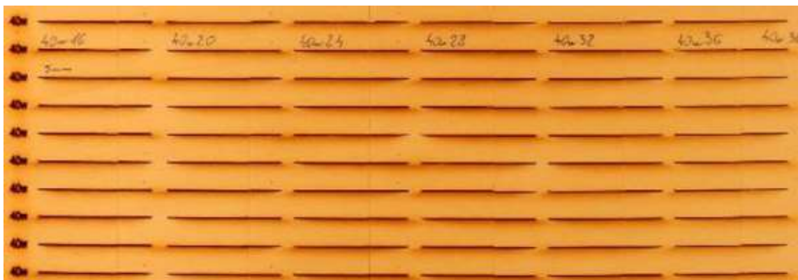
Slika 13: Izdelane zareze v preizkušanece nazivne debeline 5 mm pri 40 W moči laserskega žarka, (povečevanje hitrosti rezanja od leve proti desni) (osebni arhiv, julij 2016)
