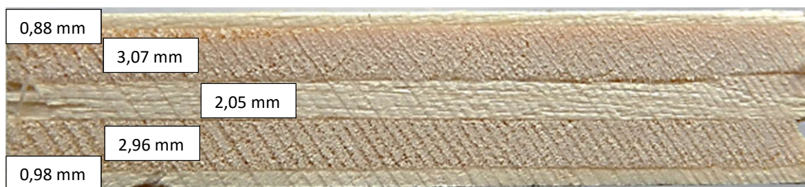
Slika 9: Prerez topolove furnirne vezane plošče nazivne debeline 10 mm (osebni arhiv, julij 2016)
