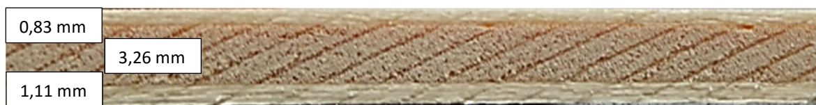
Slika 10: Prerez topolove furnirne vezane plošče nazivne debeline 5 mm (osebni arhiv, julij 2016)
