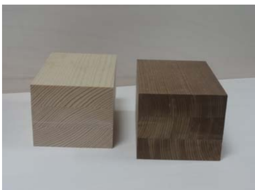
Slika 5: Poskobljan nemodificiran in termično modificiran lepljenec
