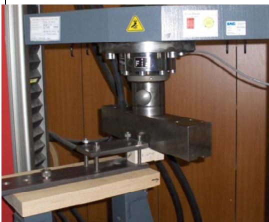
Slika 6: Testiranje strižne trdnosti lepilnih spojev na stroju Zwick Z100
