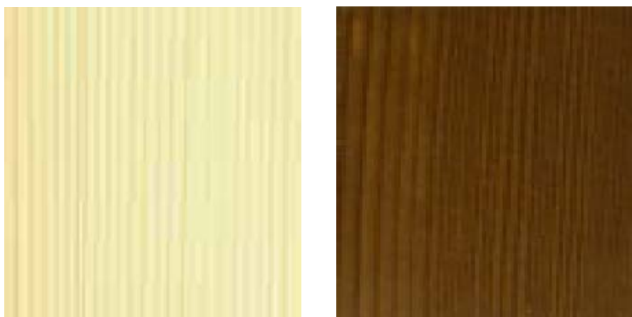
Slika 2: Nemodificirana (levo) in termično modificirana smrekovina (desno).
