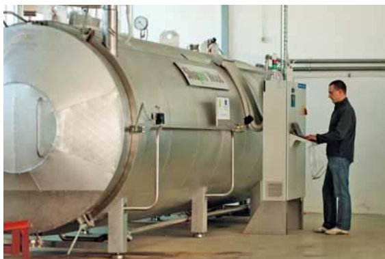
Slika 1: Vakuumska komora podjetja Silvapro produkt
