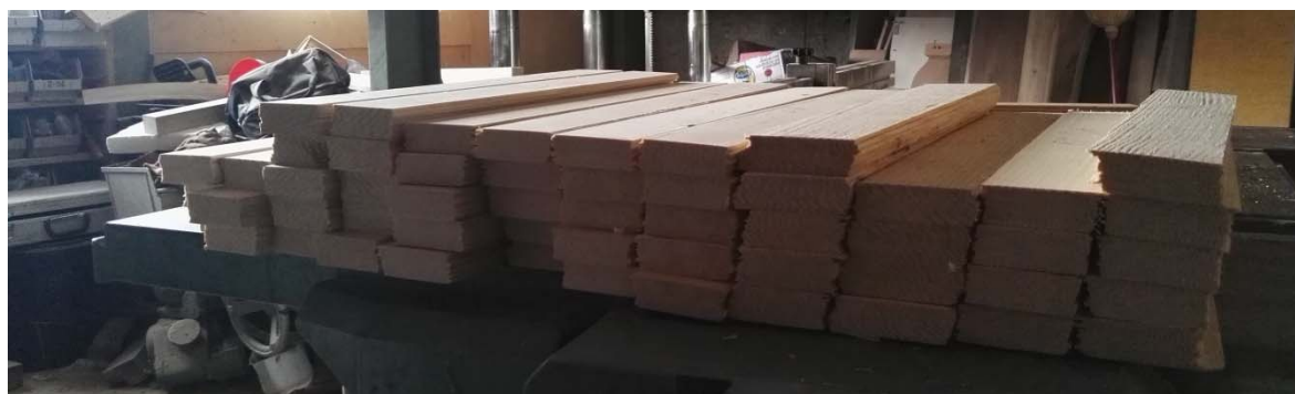
Slika 6 Preizkušanci iz slojnatega furnirnega lesa pred formatiranjem na končne dimenzije
