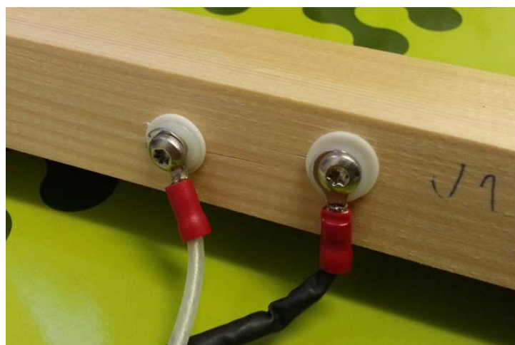
Slika 3: Prikaz standardne pritrditve elektrod za spremljanje vlažnosti v lesu (Humar in sod., 2015b)
