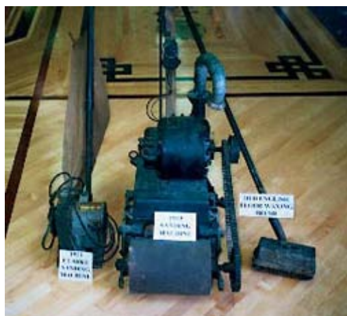
Slika 4: Prvi brusilni stroji za lesene talne obloge (Wahlgren, 1999)
